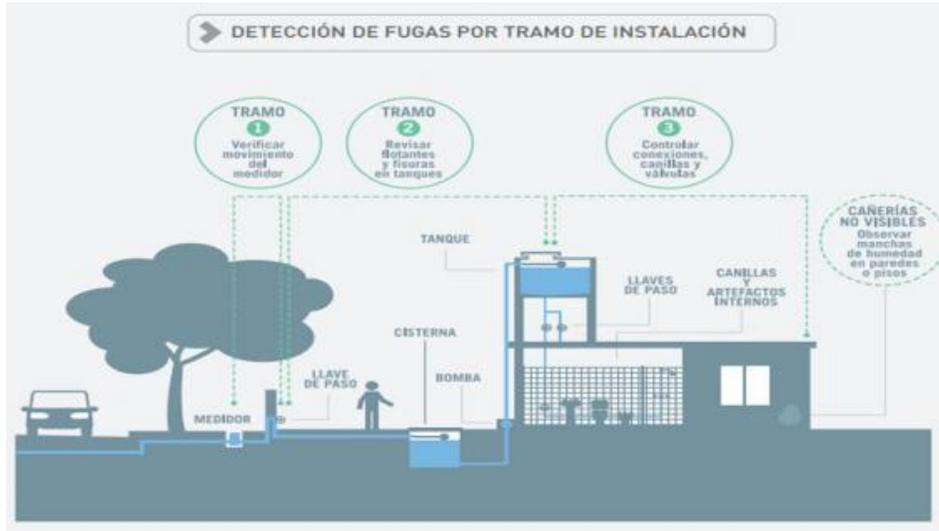
Figura 13. Diagrama de Detección de Fugas por Tramo de Instalación.
