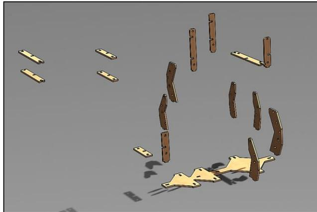
*Figura 4.29 Plantillas para sujeción de los miembros estructurales frontales del chasis*
