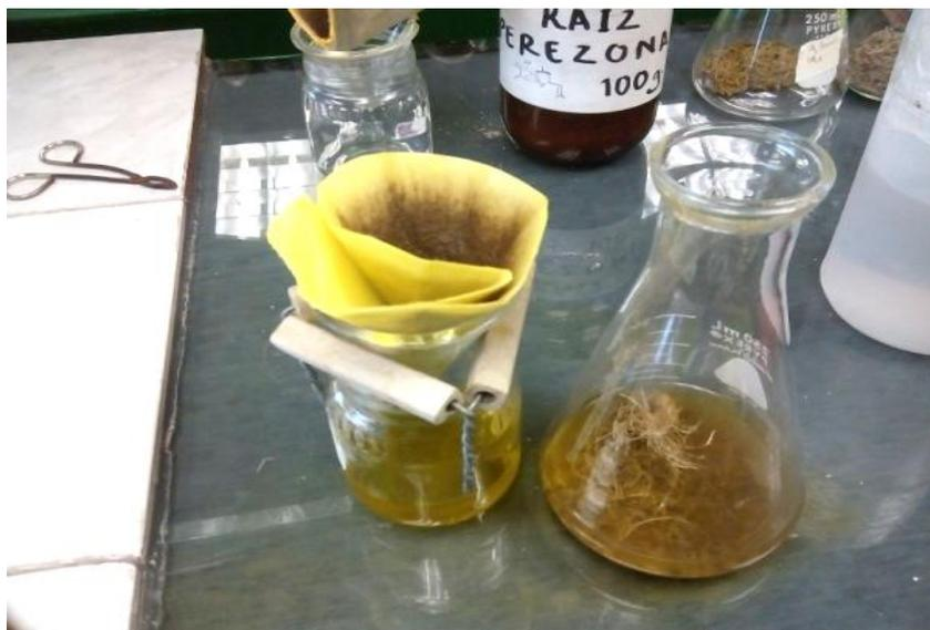
**Figura 22.** Filtración del extracto de perezona
