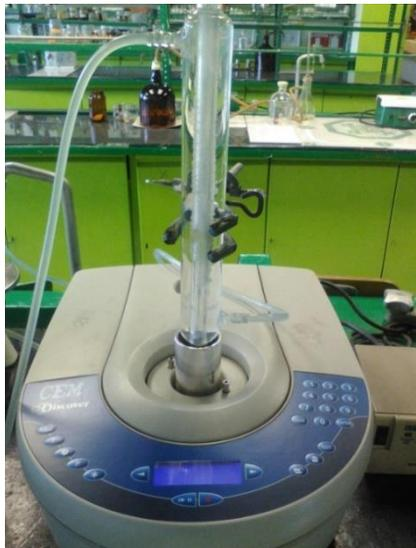
**Figura 21.** Microondas químico marca CEM Discover® empleado para en la extracción.
