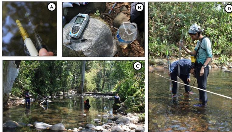
Figura 10: A) Medición de  $CE_b$ . B) Medición de  $CE_m$ . C) Medición de la CE del río cada 5 segundos. D) Medición de la velocidad con molinete.
