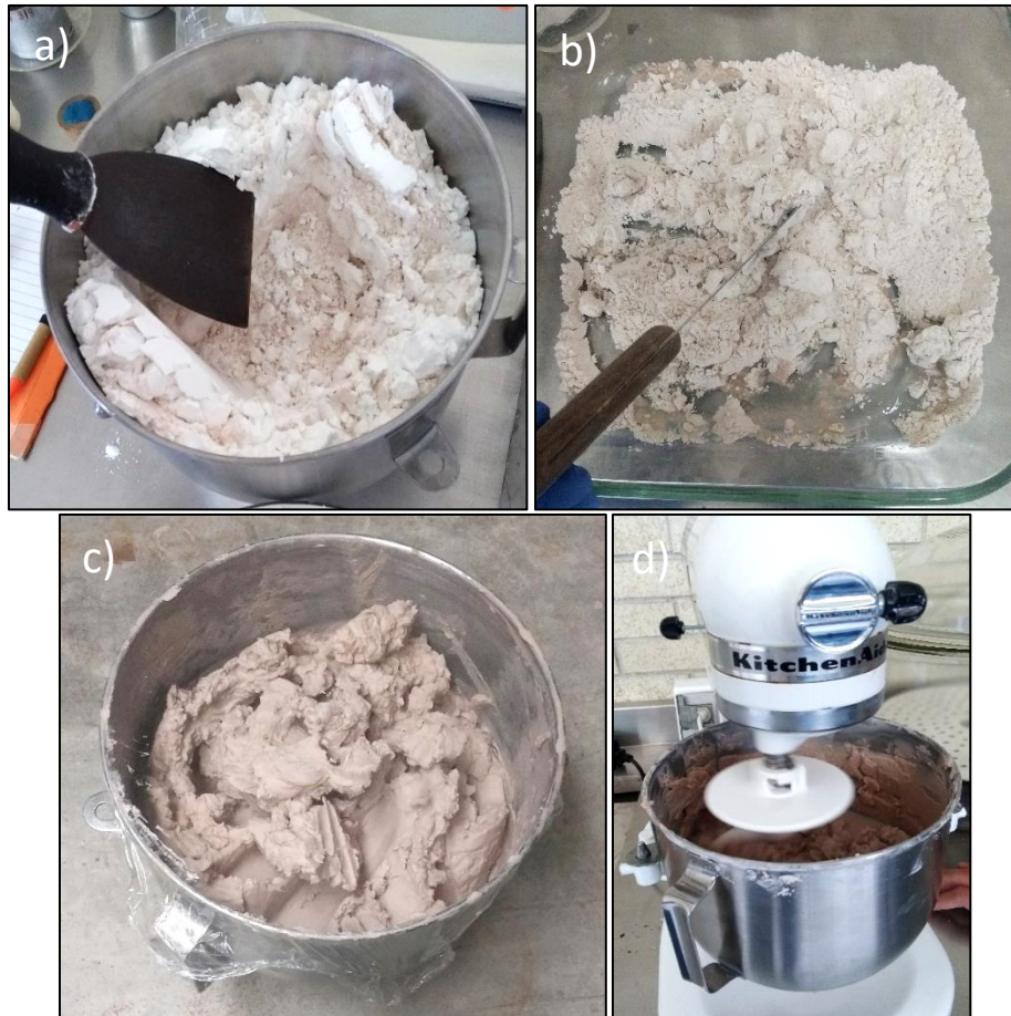
Figura 19. a) Mezclado de la bentonita y la diatomita en seco; b) Mezclado de la bentonita, la tierra diatomácea y el agua destilada; c) Reposo de la mezcla; d) Batido de la mezcla
