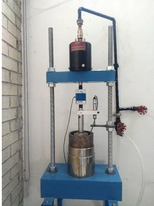
Figura 25. Fotografía del consolidómetro dinámico empleado en la presente investigación
