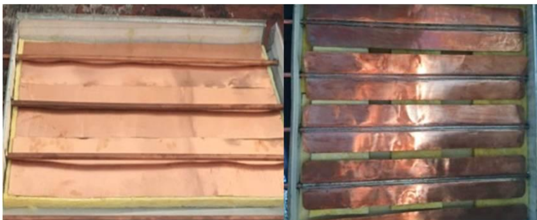
Figura 3.7: Estructura de tubos y lámina de cobre sin soldar (izquierda) y estructura ya soldada (derecha).
