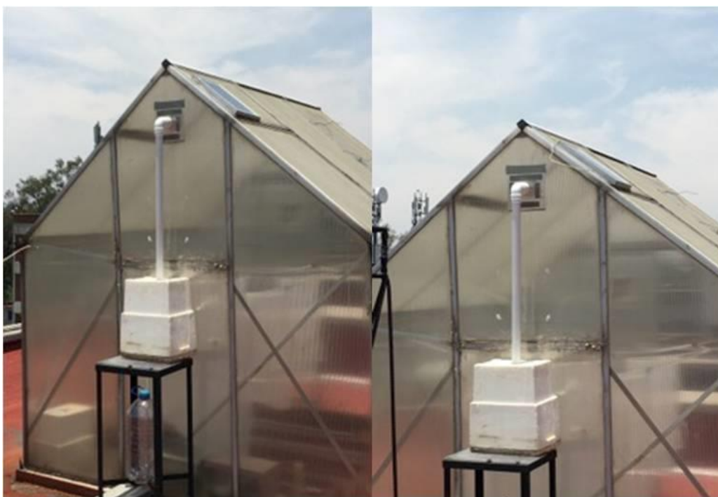
Figura 3.20: Salida del extractor hacia el serpentín.
