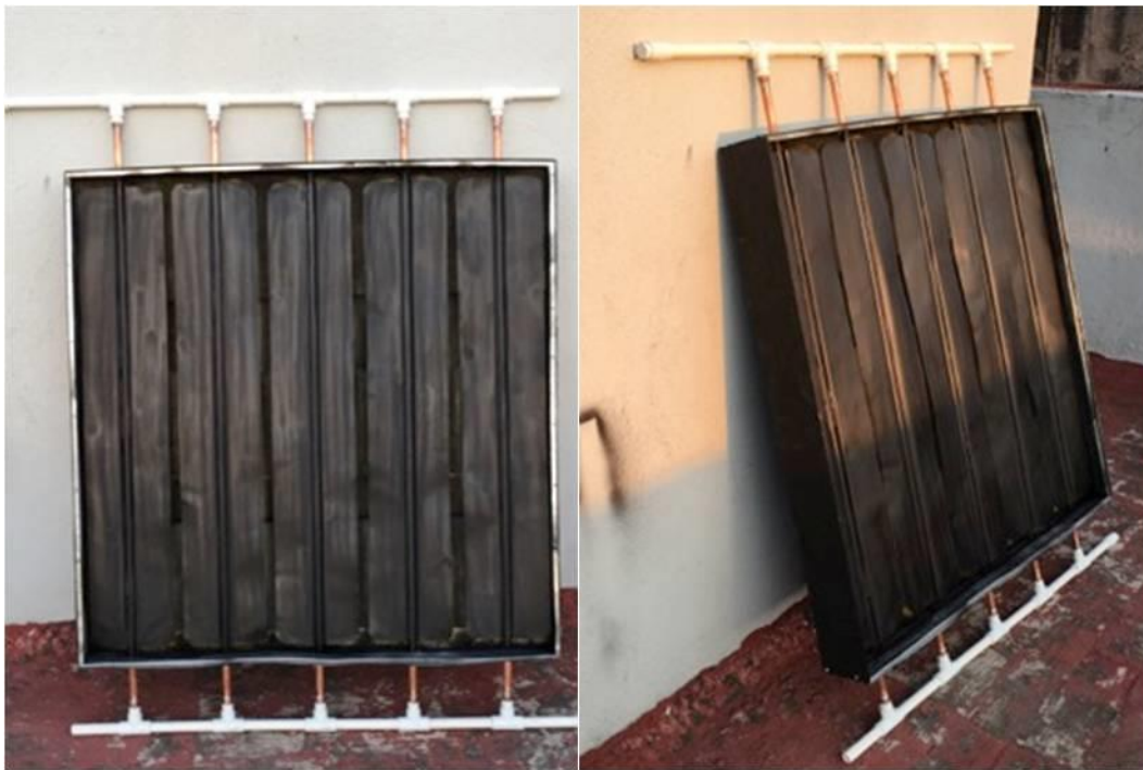
Figura 3.9: Vista frontal y lateral del colector solar y su cabezal de PVC.
