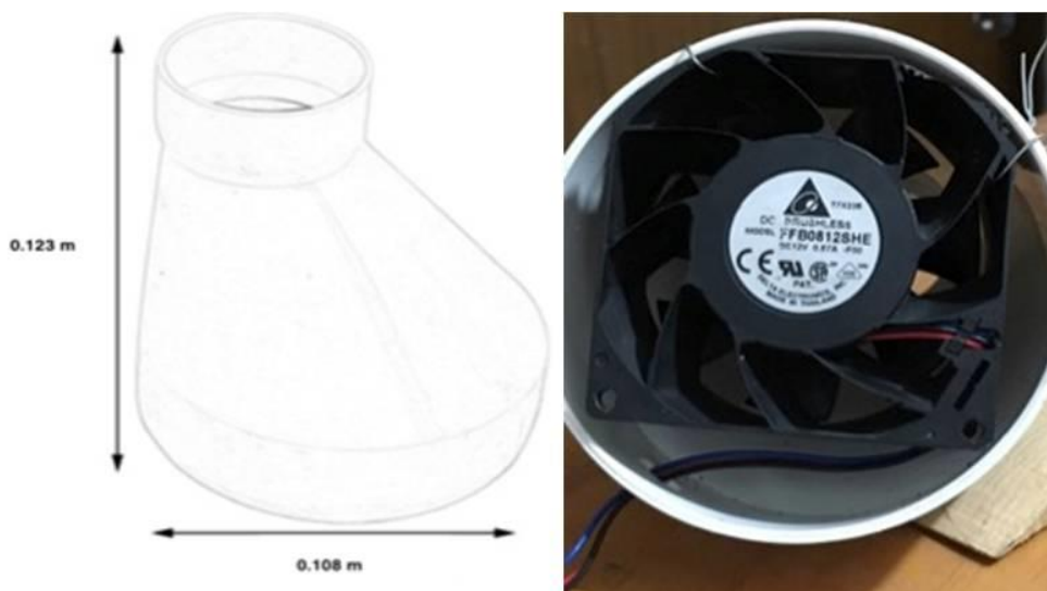
Figura 3.18: Codo con reducción para extractor (Elaboración propia, 2017).
