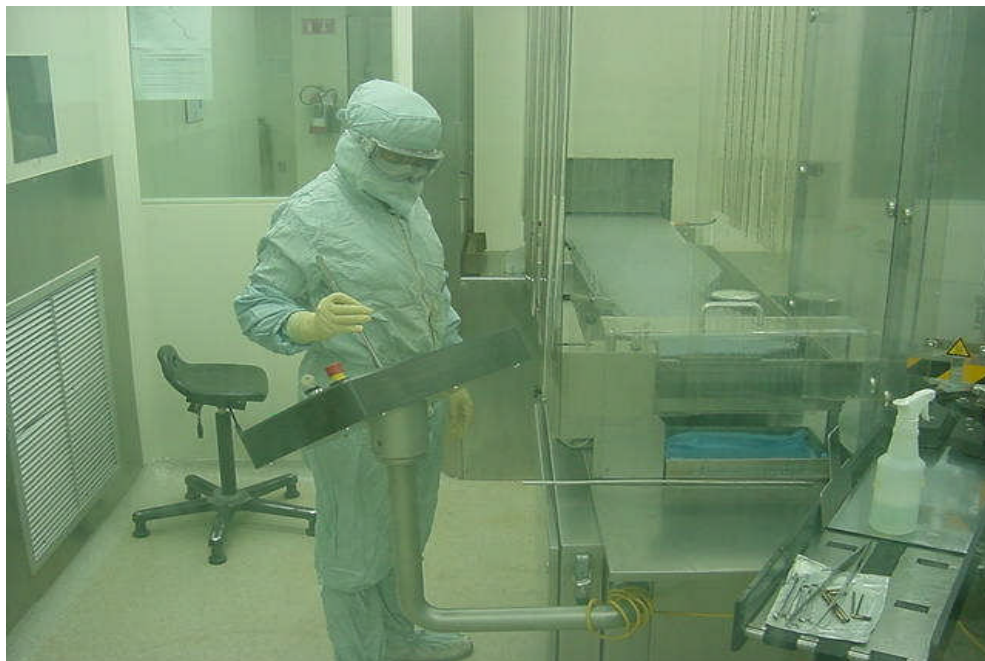
Esquema 2. Vestimenta en el área de Llenado. El Uniforme para uso en área estéril consiste en el uso de Overol, Escafandra, Mangas, Zapatones y Goggles; todo previamente esterilizado.
