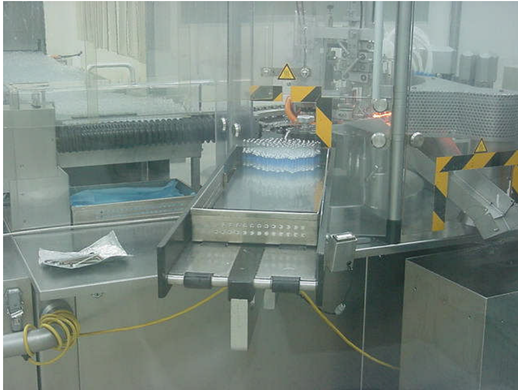
Esquema 8. La llenadora es un equipo BOSH & STROBEL, llena un promedio de 9000 ampolletas por hora.
