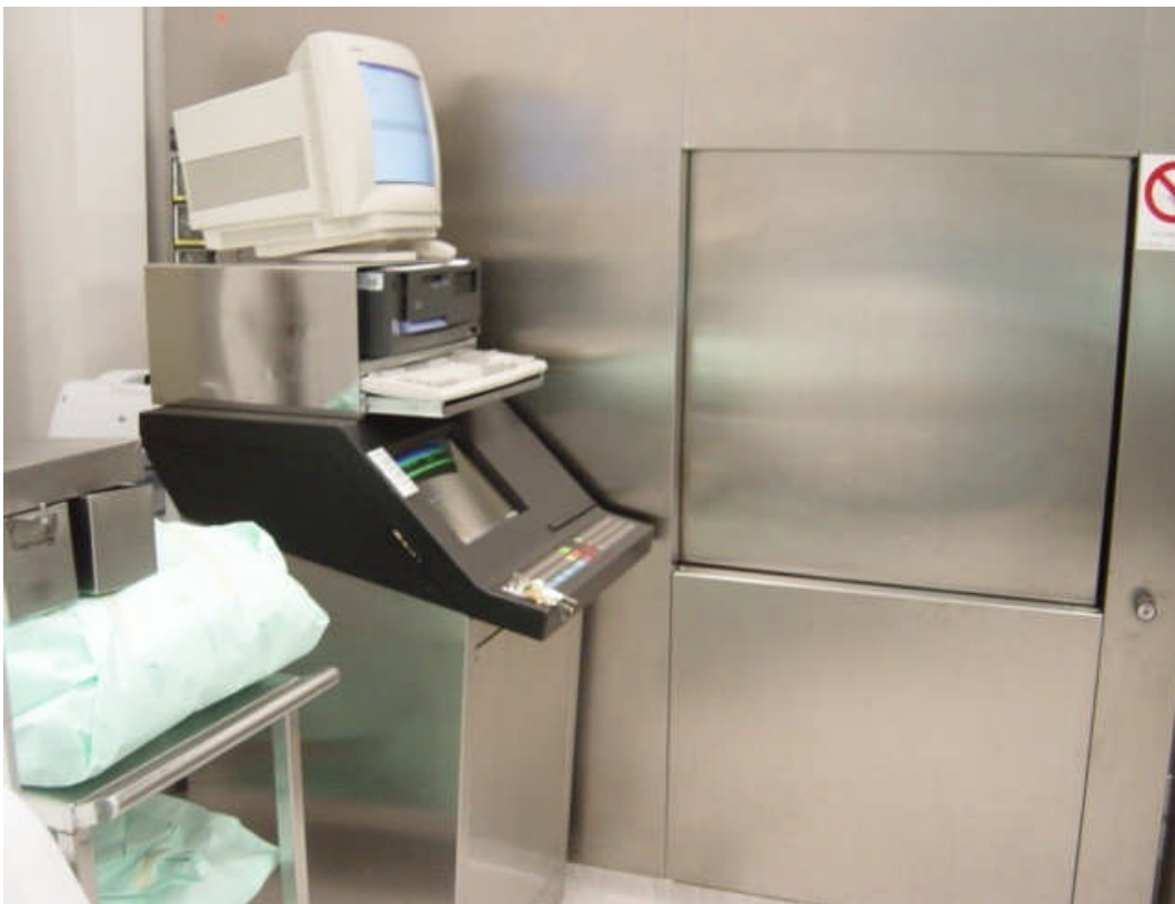
Esquema 6. Autoclave. El autoclave es de doble entrada como se observa es la vista externa, es decir, donde se introducen los materiales a esterilizar.
