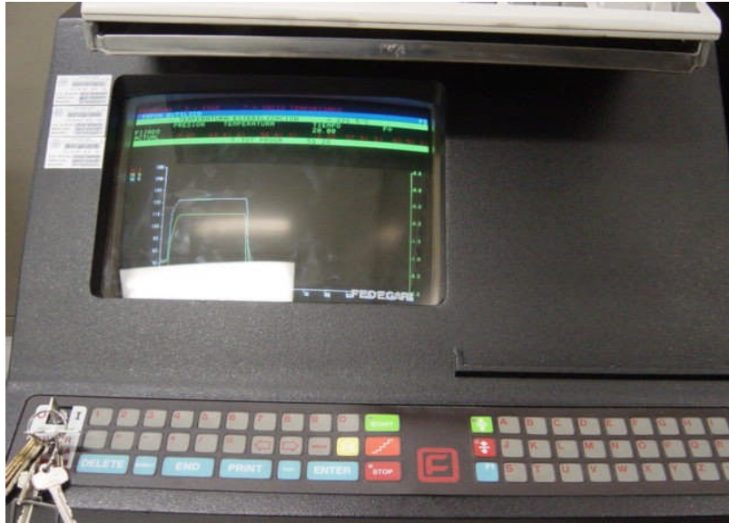
Esquema 7. Monitor. Este equipo esta integrado a el autoclave y se registran las etapas de esterilización.
