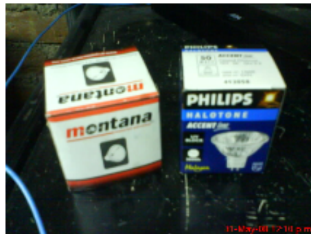
Fig. 4.5 A la izquierda tenemos el dicroico ahorrador de 1 W, a la derecha el normalmente usado de 50W
