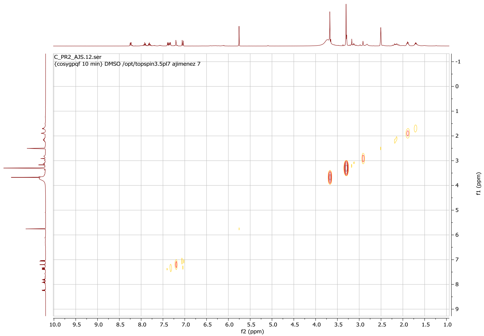
Espectro 2.5- Espectro COSY de 9- (2-carboxifenil)-6-(dimetilamino)-1,2,3,4-tetrahidroxantilo en DMSO- \delta_6 , 400 MHz.
