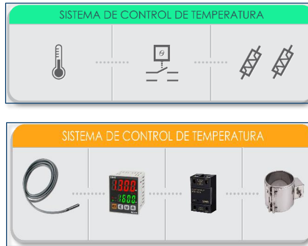
Figura 0.43. Sistema de control de temperatura
