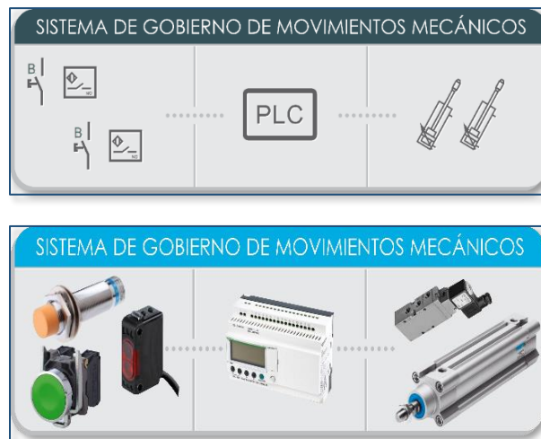
Figura 0.40. Sistema de control de movimientos mecánicos
