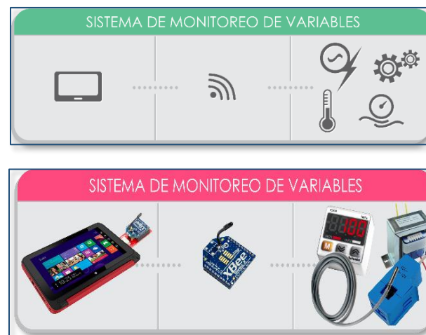
Figura 0.42. Sistema de monitorización de variables
