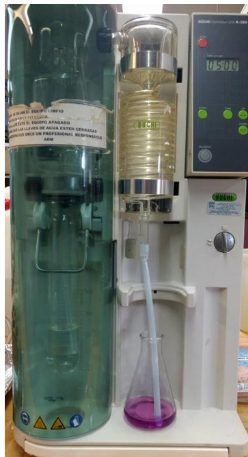
Figura 29. Equipo destilador Büchi para determinación de Nitrógeno Amoniacal.
