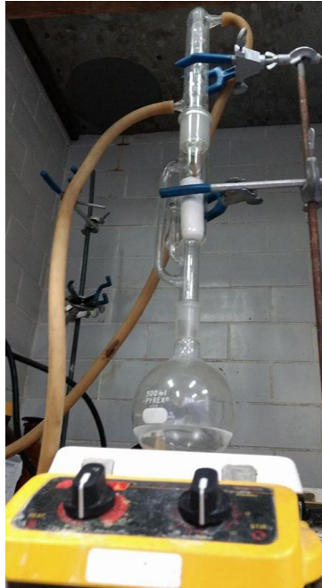
Figura 30. Montaje de equipo de extracción de grasas y aceites por recirculación.
