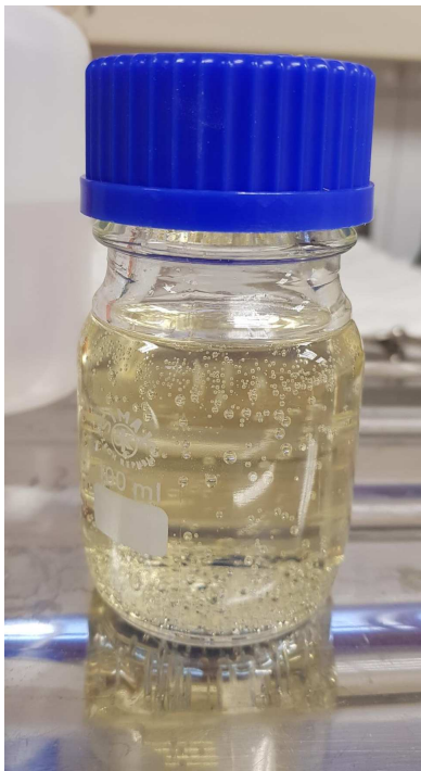
Figura 5.1: Formación de burbujas de CO_2 bajo condiciones normales de temperatura y presión, para una mezcla de MEA(10\%w) + H_2O(90\%w) + CO_2 que previamente estuvo saturada de gas a altas presiones y temperatura.
