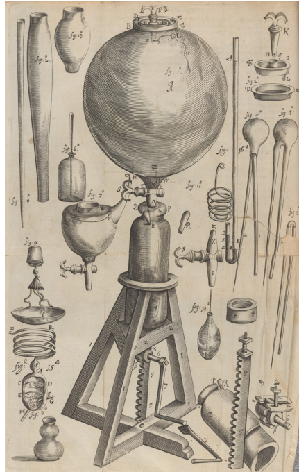
Imagen 1.4. Dibujo de la bomba de vacío que utilizó Robert Boyle para sus experimentos (tomada de Shapin & Shaffer, 2005).
