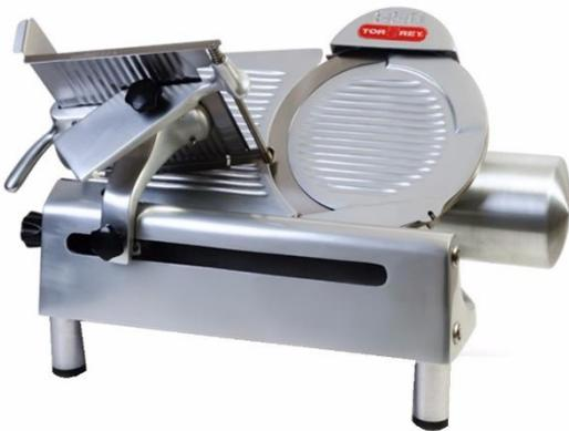
Estos equipos son los encargados de rebanar los distintos tipos de jamón, consta de una cuchilla que gira a revoluciones altas y permite el corte delgado del jamón.
