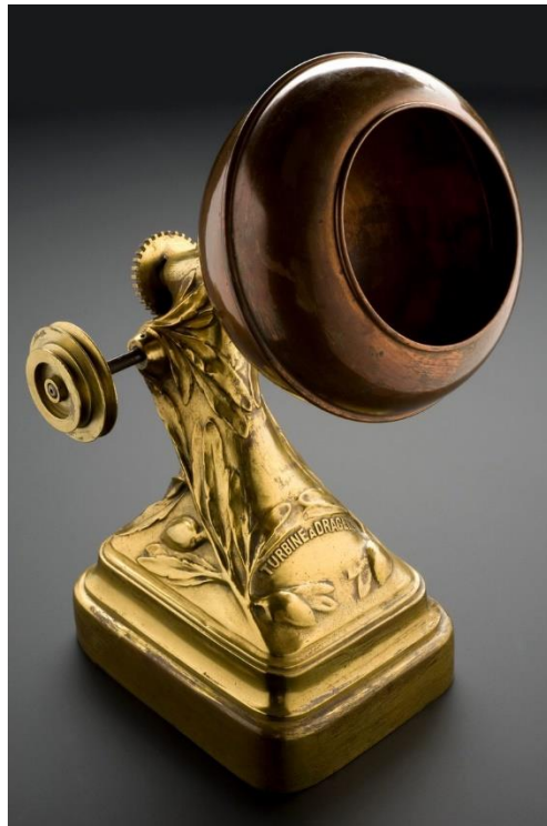
Figura 4.1 Bombo convencional de recubrimiento de tabletas, Francia 1915-1925. Imagen tomada de https://wellcomecollection.org/ , Museo de Ciencia de Londres, 04Abr2019.
