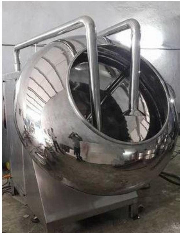
Figura 4. 2 Bombo de recubrimiento con sistema de entrada y escape. Imagen tomada de https://www.sbmachtech.com/conventional-coating-pan-1778339.html , 20Abr2019.
