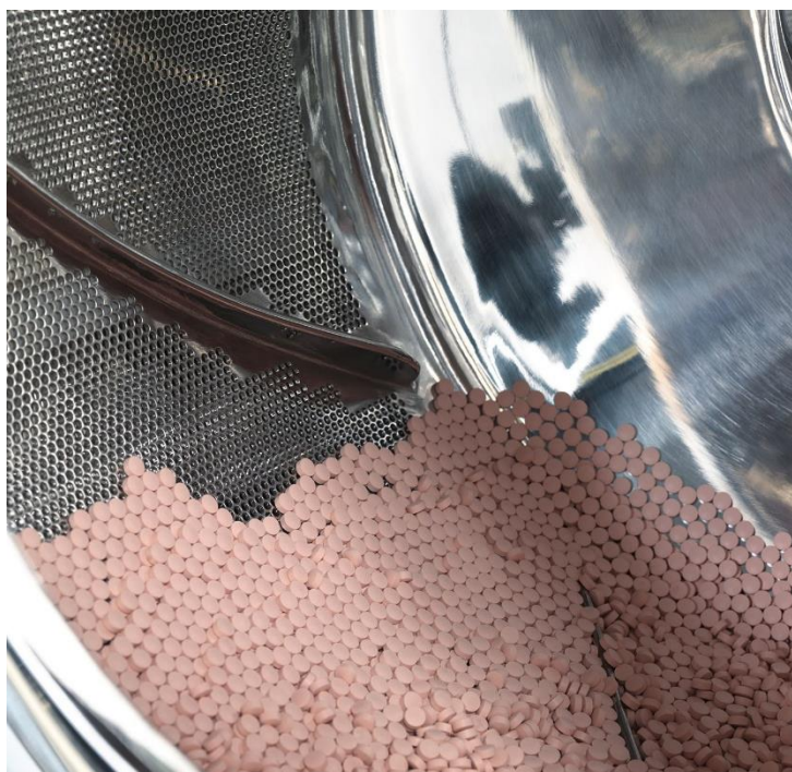
Figura 4.14 Deflectores/ Baffles dentro de un bombo perforado. Imagen tomada de https://ima.it/ , 05May2019
