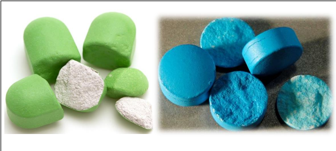
Figura 6.10 Ruptura de las tabletas Imágenes tomadas de Ashland.com, 09Mar2019
