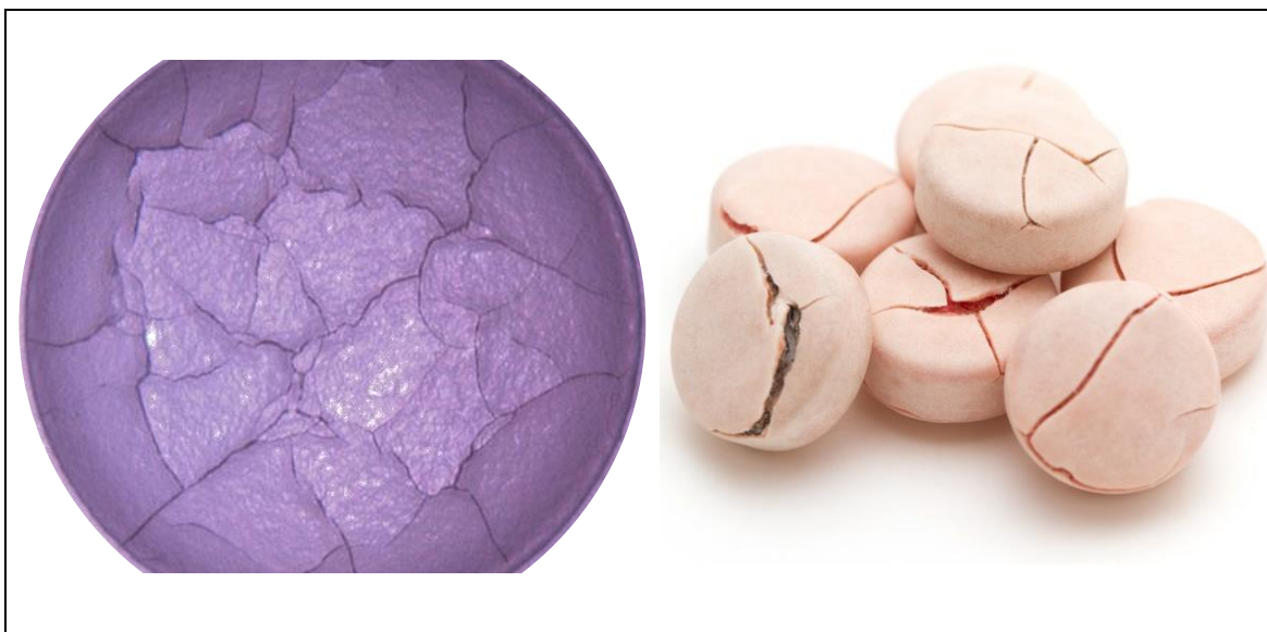
Figura 6.4 Tabletas con agrietamiento. Imágenes tomadas de Ashland.com, 09Mar2019
