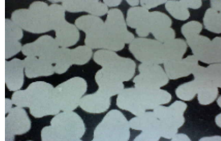
Fig. 20. Acetato secundario de celulosa. Sección transversal a 750 aumentos.
