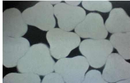
Fig. 28. Poliamida (Nylon 6,6) trilobal. Sección transversal a 500 aumentos.
