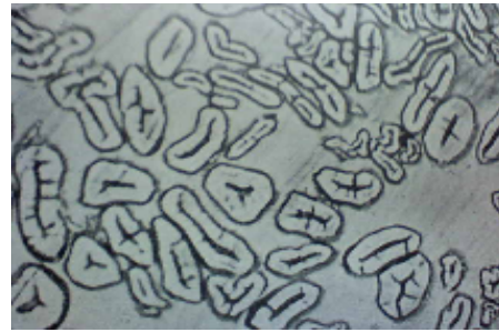
Fig. 18. Fibras de ramio. Sección transversal a 340 aumentos.
