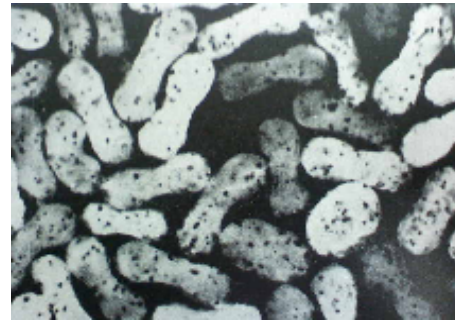
Fig. 34. Fibra acrílica (Orlon tipo 42). Sección transversal alargada a 750 aumentos.
