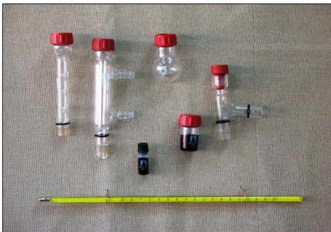
Fig.1. Componentes del equipo para la destilación fraccionada
