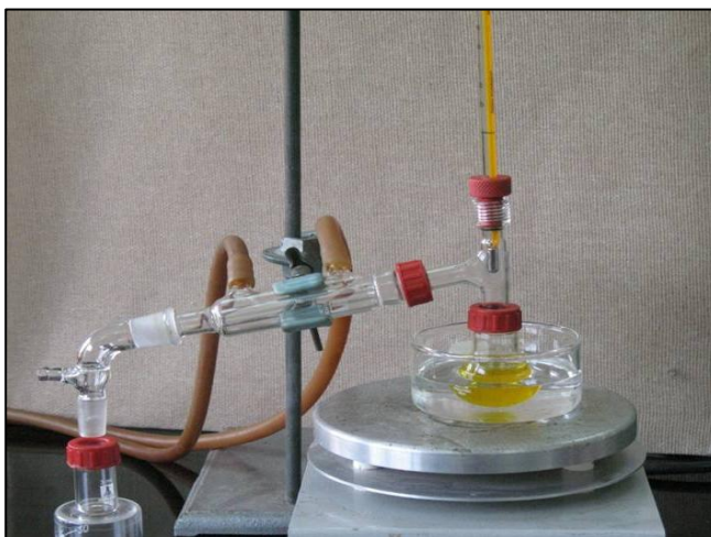
Fig. 2. Equipo de destilación simple a escala semimicro
