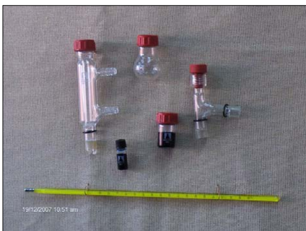
Fig. 1 Componentes del equipo de destilación simple
