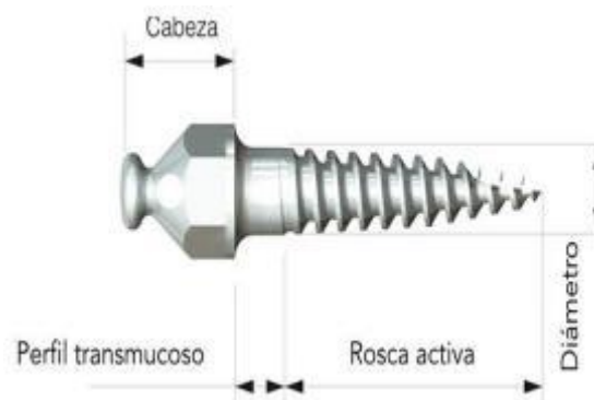
Fig. 31 Partes de un microtornillo
