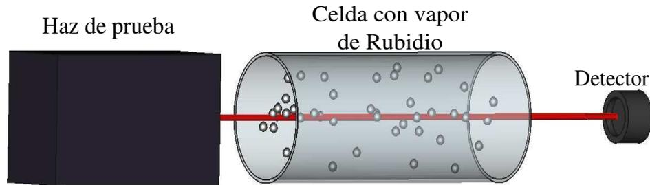
Figura 1.3: Esquema básico de espectroscopía de absorción, fuente de luz, muestra y detector.
