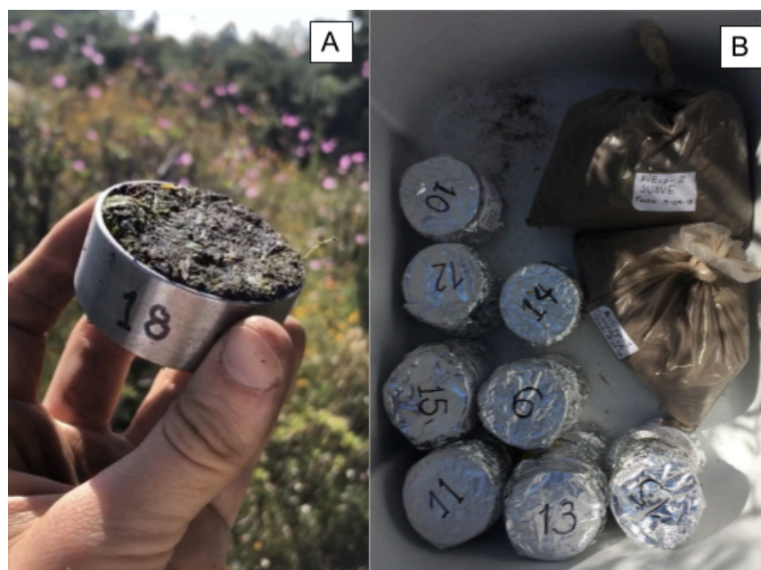
Figura 8. (A) muestra de CC-PMP en cilindro de acero inoxidable; y (B) muestras empaquetadas y numeradas.
