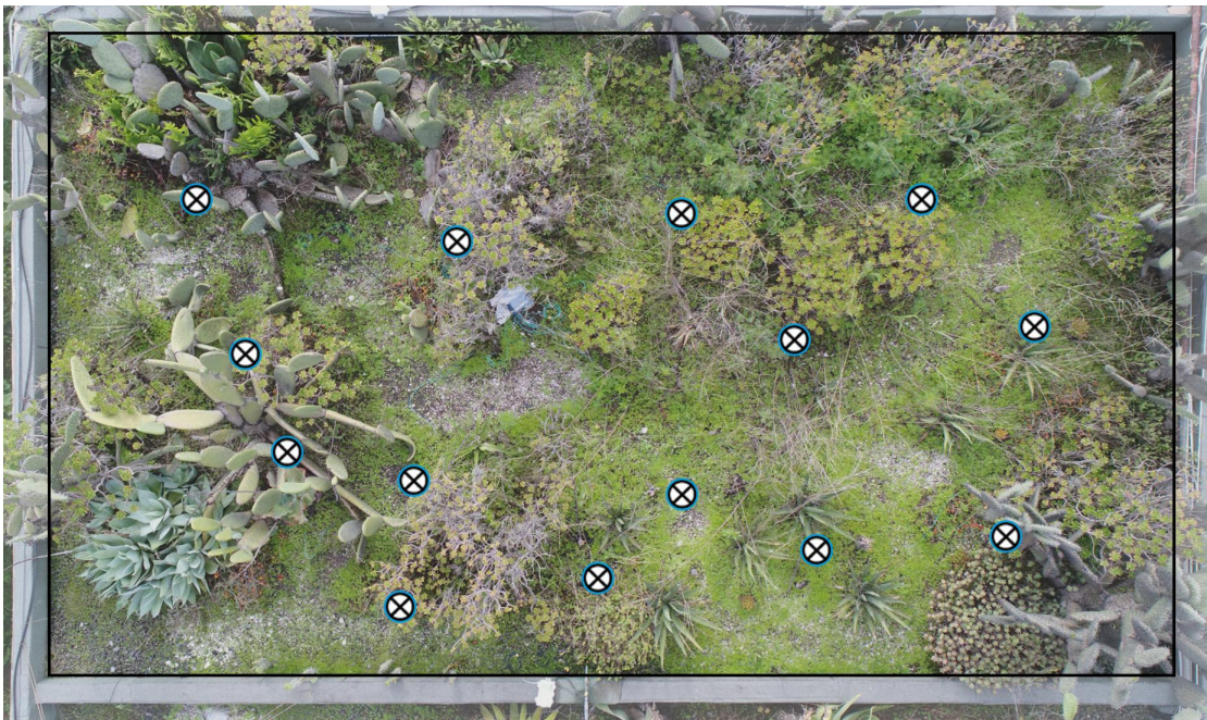
Figura 5. Ubicación de los sensores de capacitancia en la AVEsp.
