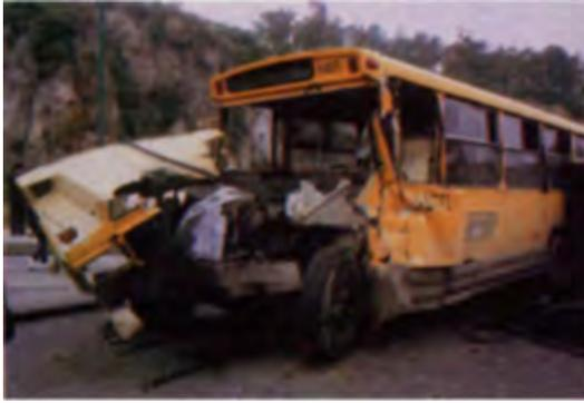
Figura 11. Acercamiento de los daños del autobús de la ruta 100, que presenta alteraciones en la parte frontal media izquierda, así como en su vértice por hundimiento hacia atrás y hacia el centro del vehículo, lo que afecta: defensa, tolva, brack, chasis, coraza completa, cofre y unidades de luz, entre otros.<sup>95</sup>
