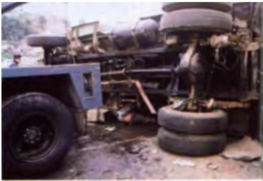
Figura 12. Se aprecia toda la parte inferior del vehículo tipo volteo, el cual se halla sobre un sujeto de sexo masculino que está sobre el asfalto; las bombas de aire de los frenos del camión están dañadas, los neumáticos posteriores derechos se observan semilisos, además se encuentran trabados por la pérdida de aire de la bomba de los frenos, lo cual se deduce por la fricción de rodamiento que presentan los neumáticos inferiores.<sup>96</sup>
