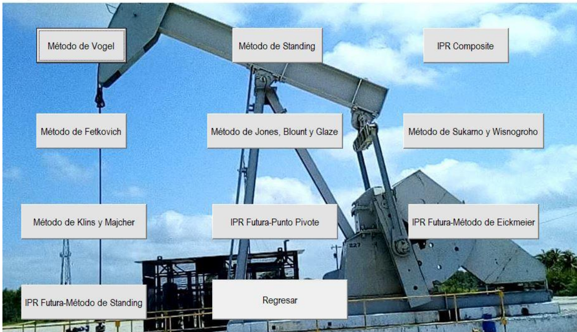
Figura 6.3 Ventana para la selección del método de cálculo del comportamiento de afluencia.
