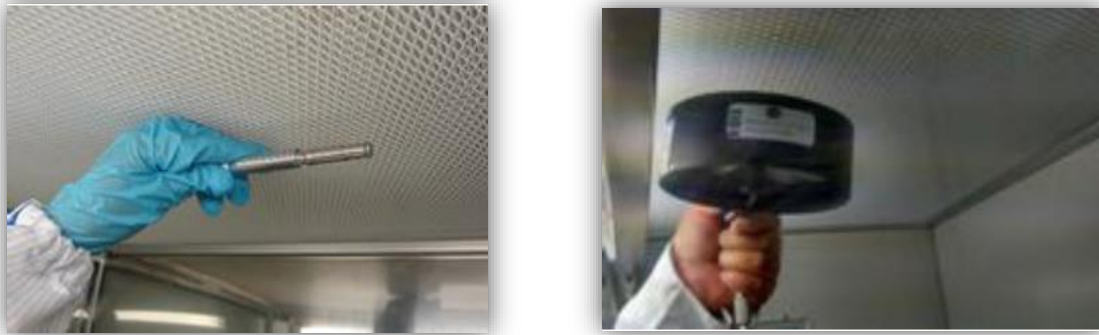
Figura 58. Sonda de hilo caliente y veleta utilizadas en la Prueba de Velocidad de Aire
