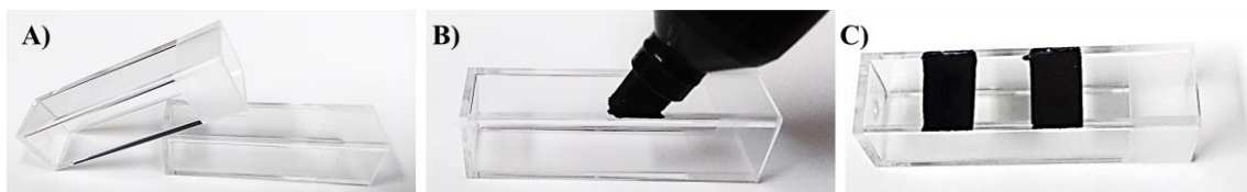
Figura 6.2 A) Celdas de espectroscopia de poliestireno. B) Pintado de celda con marcador negro. C) Celda pintada para realizar dos grabados.
