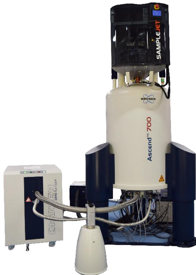
Figura 6. Espectrómetro Bruker Avance III HD 700 MHz (campo magnético de 16.4 T).
