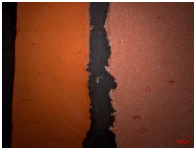
Figura 42. Micrografía Digital 20x de la pintura Naranja 308 con tiempo de envejecimiento 976 h. La sección izquierda fue cubierta con papel aluminio durante el envejecimiento acelerado mientras que la sección derecha fue expuesta directamente a radiación UV (340 nm).
