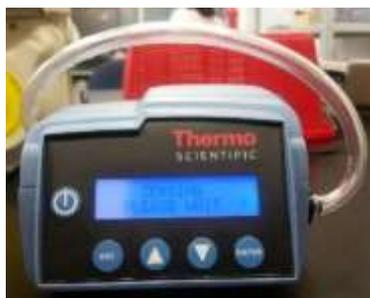
*Ilustración 50. Calibración cero del equipo pDR 1500*
