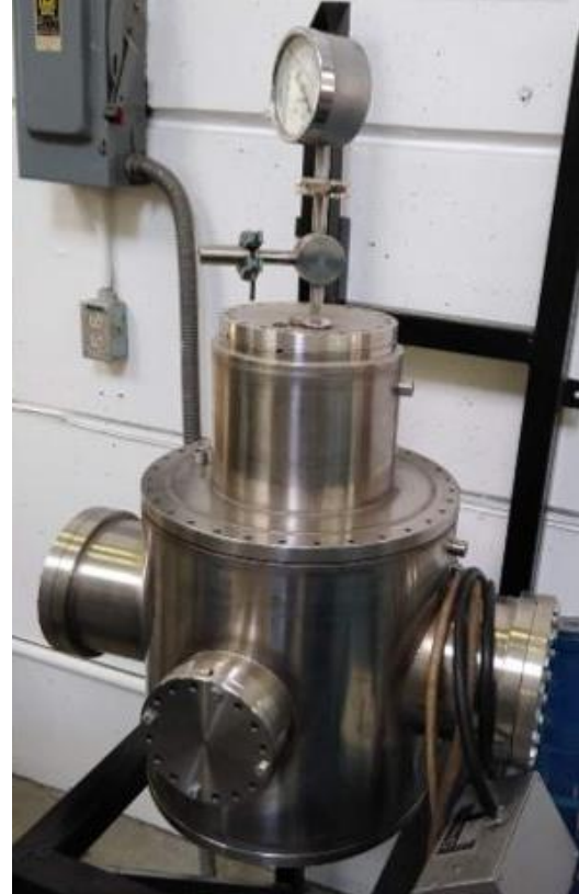
Figura 12. Fotografías tomadas a cámara para fusión electromagnética antes de ser intervenida
