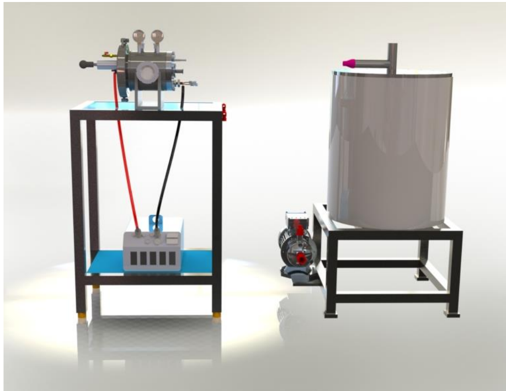
Figura 48. Diferentes vistas de modelo ilustrativo de sistema completo para fusión por arco eléctrico
