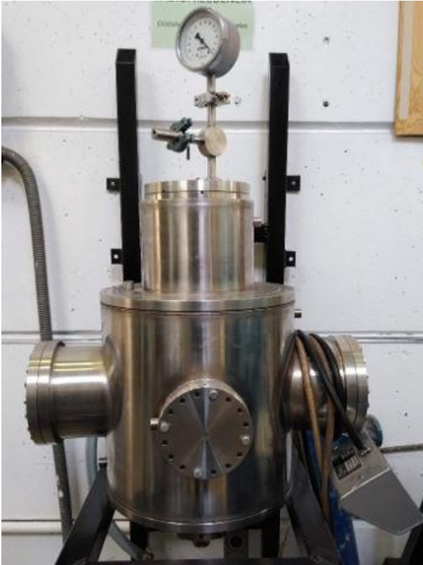
Figura 12. Fotografías tomadas a cámara para fusión electromagnética antes de ser intervenida
