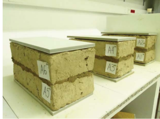
Fig. 11.- Preparación de las tres probetas con bloques de adobes.
