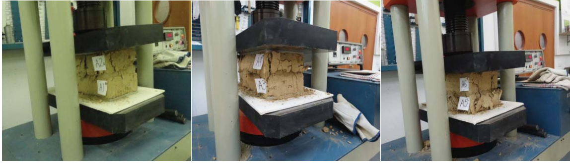
Fig.13.- Ensayo de resistencia a compresión en bloques de adobe.
