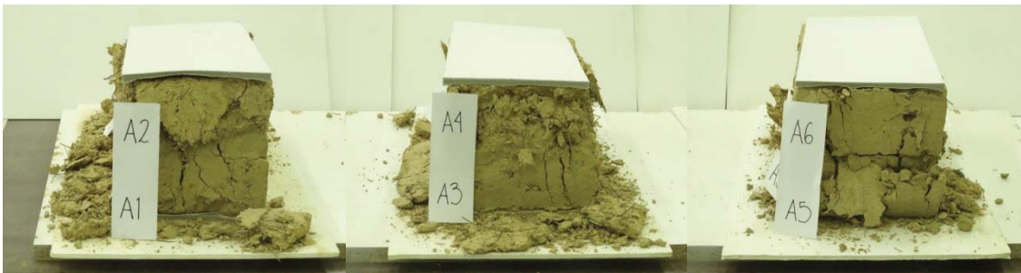
Fig. 14.- Resultado de adobes en ensayo de resistencia a compresión.
