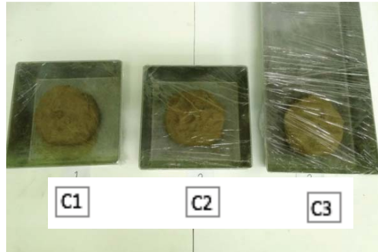
Fig. 5.- Tres probetas de barro en reposo.
