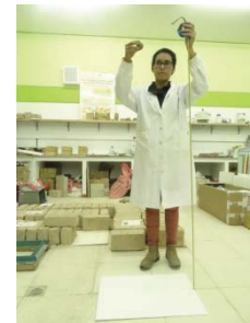
Fig. 1.- Ensayo de caída de bola.
