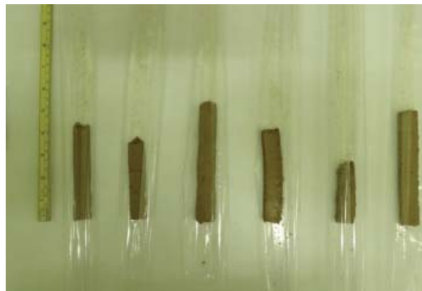
Fig. 10.- Resultados de distancia de rotura en tiras de barro por ensayo de cohesión.
