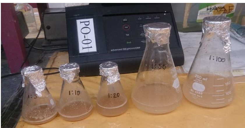
Figura 4.6. Ensayos de extracción realizados, 1:5, 1:10, 1:20, 1:50 y 1:100 (de izquierda a derecha)
