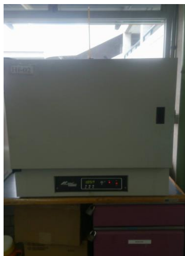
Figura 3.2. Horno de convección marca Felisa, Modelo F-293 D
