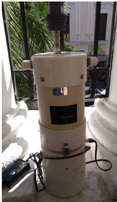
Figura 2.4. Mini-Vol. Modelo 3380, Airmetrics.
