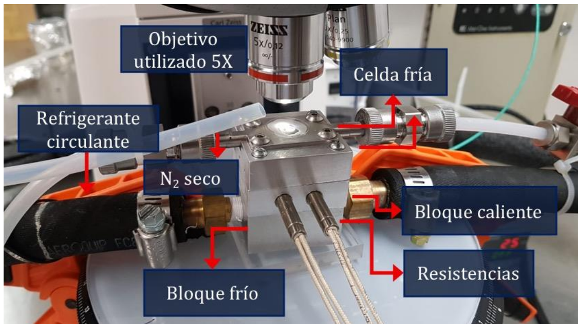
Figura 2.20. Sistema del DFT con el bloque frío, el bloque caliente y la celda donde se encuentra el cubreobjetos aislado.
