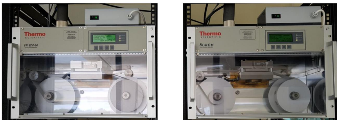
Figura 2.3. Analizadores de PM_{10} y PM_{2.5} , respectivamente.
