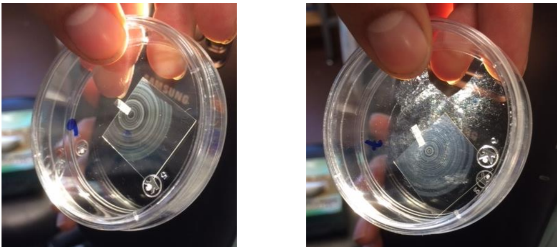
Figura 2.8. Cubreobjetos de las etapas 6 y 7 del MOUDI. A cada uno de los cubreobjetos se les coloca una pequeña cinta con el fin de que queden pegado a la caja Petri de 60 mm y no se pierda parte de la muestra.
