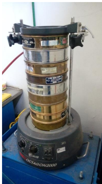
Figura 5.2 Ro-Tap y juego de mallas utilizados para el análisis granulométrico
