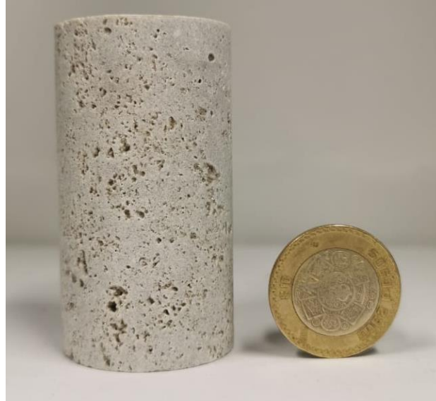
Figura 5.10: Muestra de roca Guelph Dolomite seleccionada para realizar la imbibición capilar espontánea.
