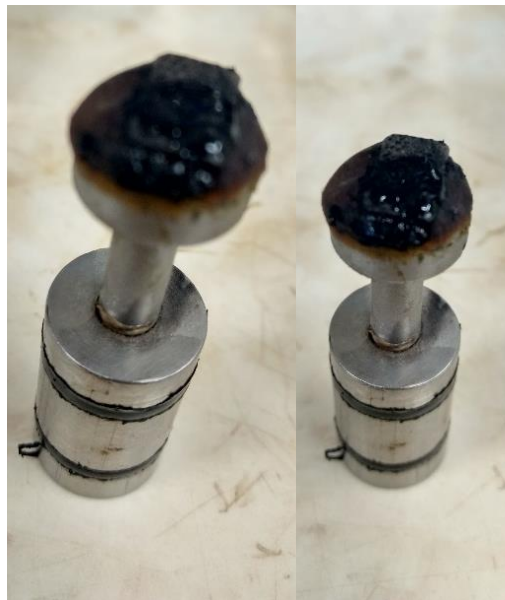
Figura 5.9: Precipitados en el capilar del equipo de medición del ángulo de contacto.
