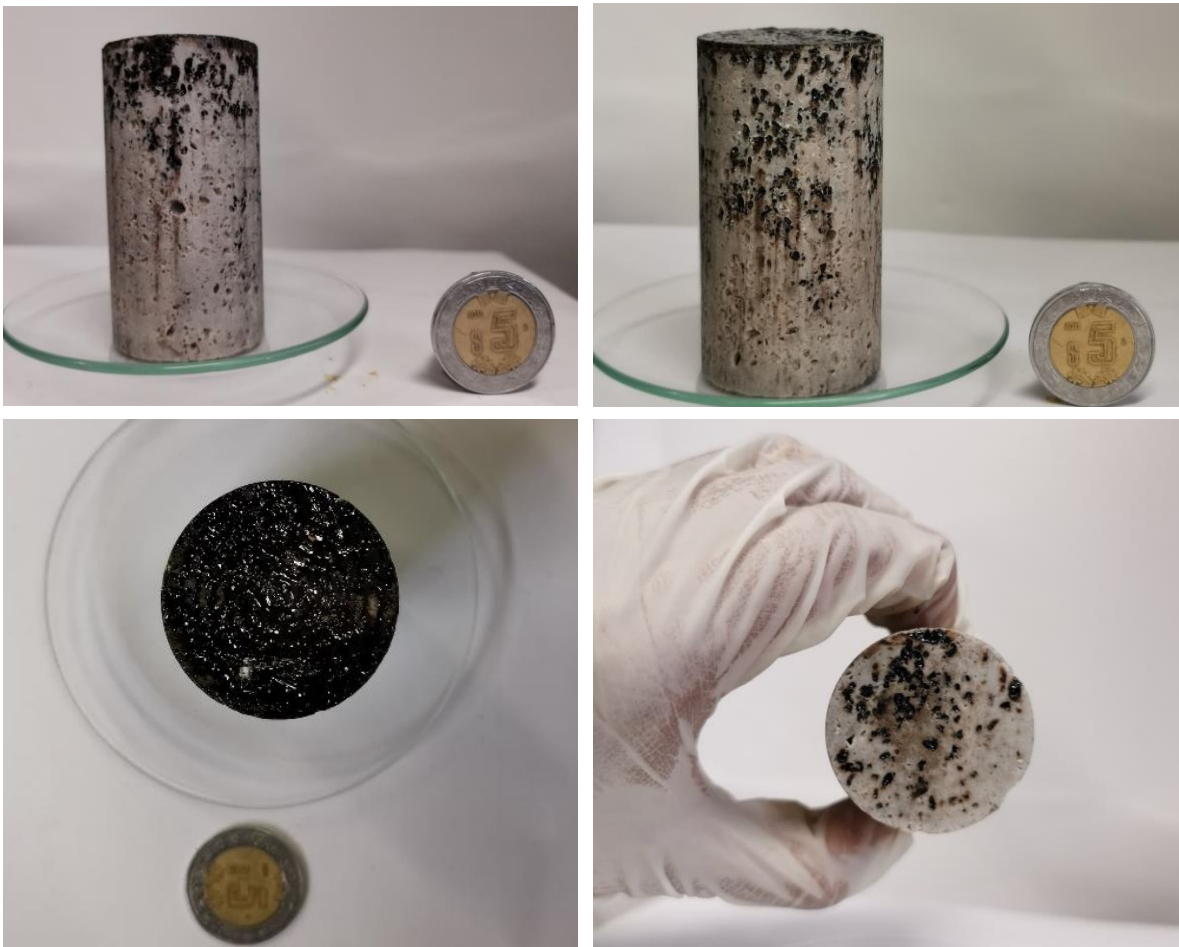
Figura 5.14: Tapón de roca Guelph Dolomite llevado a condiciones de S_{wirr} .
