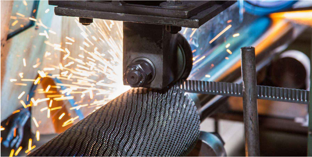
Figura 1.11: Fabricación de tubo con aletas segmentadas. En: https://vulcanfinnedtubes.com
