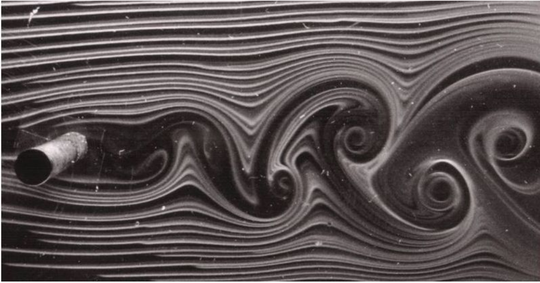
Figura 1.4: Flujo alrededor de un tubo. En: http://mae.ntu.edu.sg
