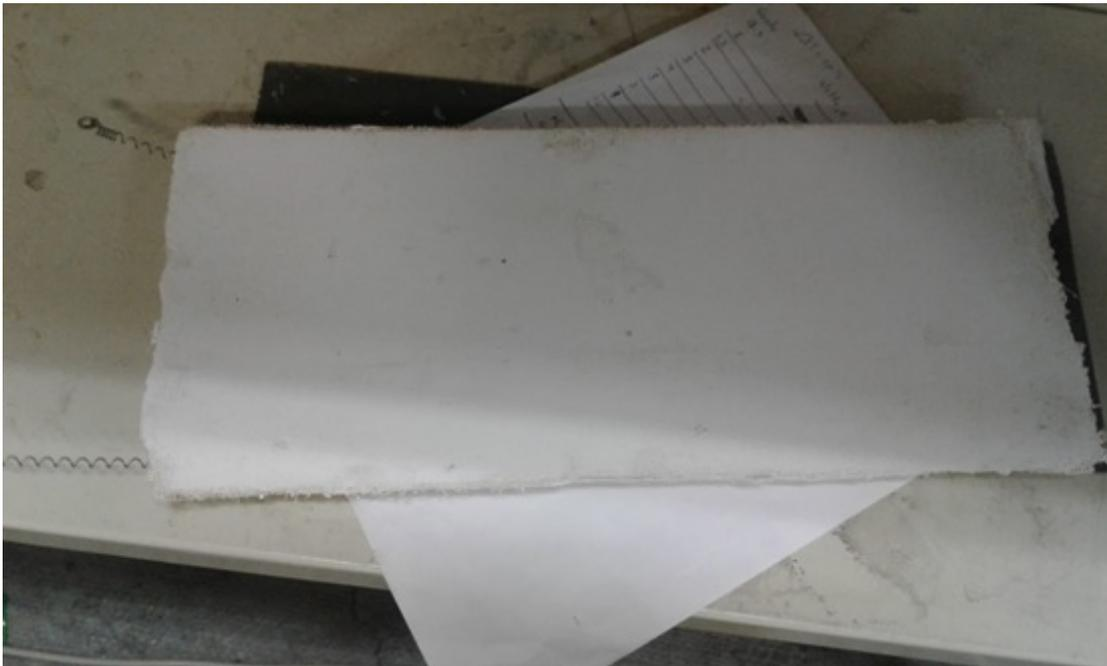
**Figura 3-3: Arreglo de yeso con la resistencia eléctrica**
