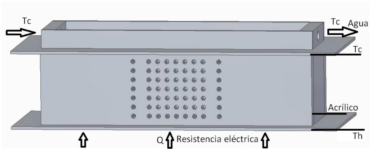
Figura 2-22: Representación esquemática del problema
