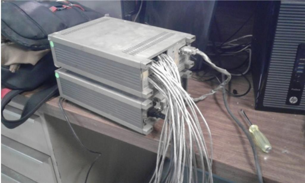
**Figura 3-11: Termómetro de 30 canales parte posterior**
