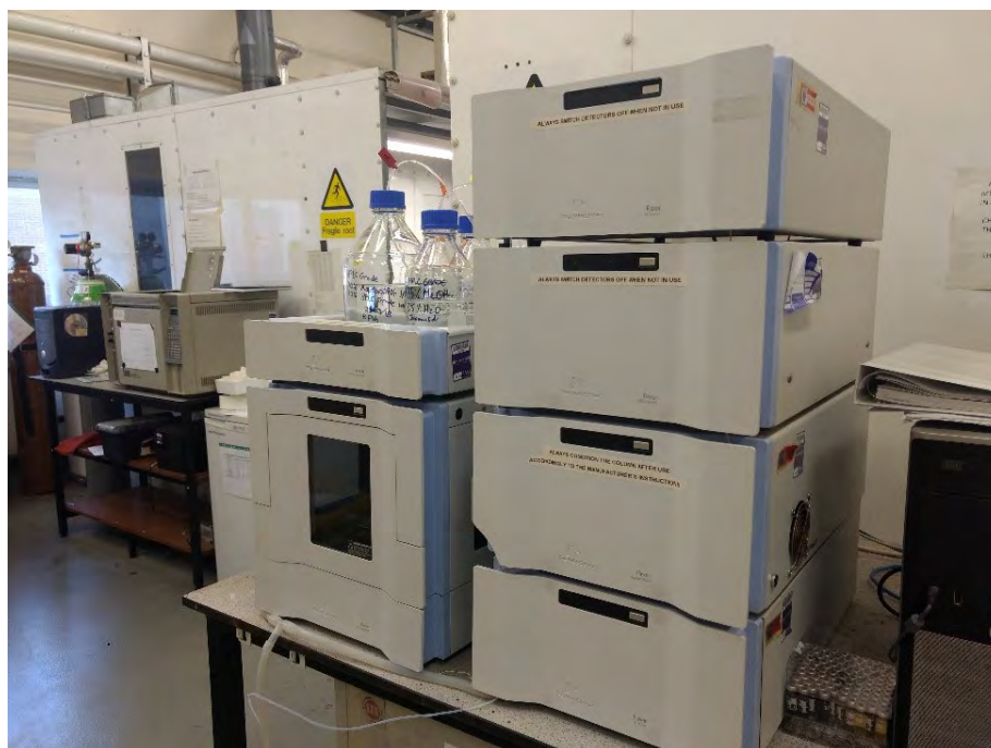
Figura 7.8. Vista general del equipo de cromatografía líquida de alta resolución utilizado en la Universidad de Newcastle
