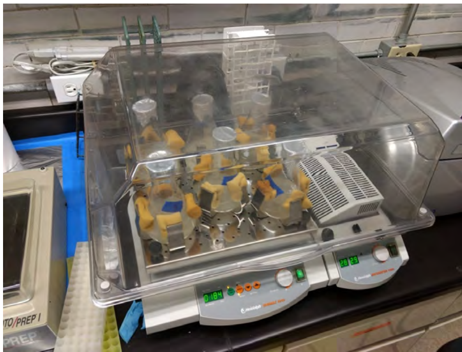
Figura 7.7. Cultivo de levaduras silvestres en incubadora con agitación orbital
