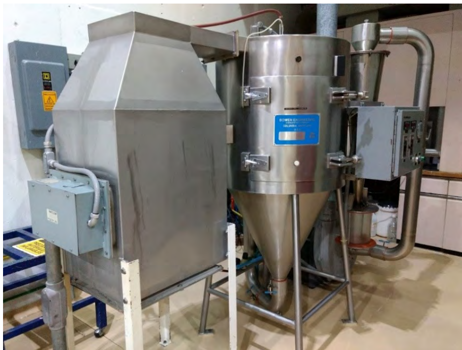
Figura 7.4. Preparación de equipo de secado por aspersion Bowen Engineering BE-1449
