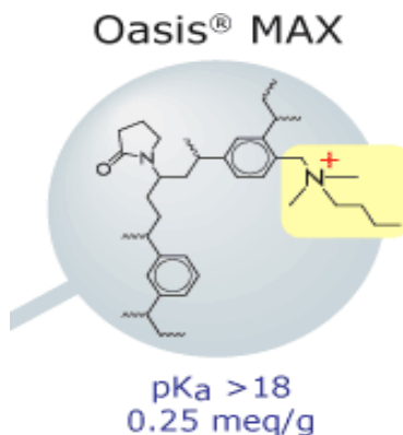
Figura 12. Estructura de los cartuchos Oasis® MAX
