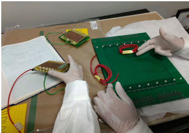
Figura 3.8: MRPC con las 6 placas de vidrio en el interior y las dos PCBs cubriéndolas.
