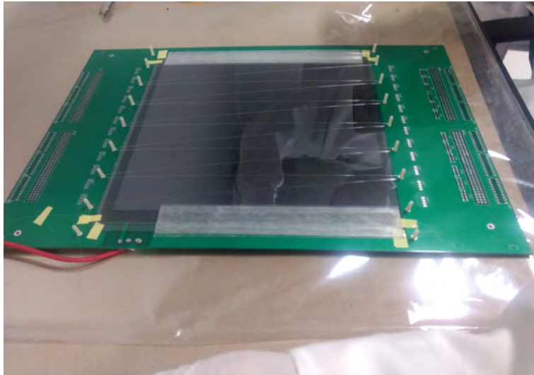
Figura 3.6: MRPC durante el proceso de ensamblado. El arreglo geométrico es importante para lograr el espaciado de 260 \mu\text{m} .
