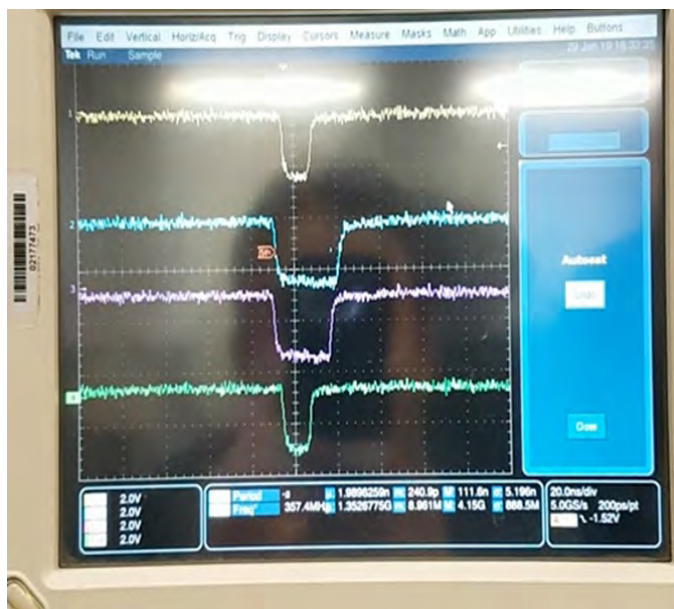
Figura 4.13: Señales de salida diferenciales de cuatro canales de la tarjeta NINO.
