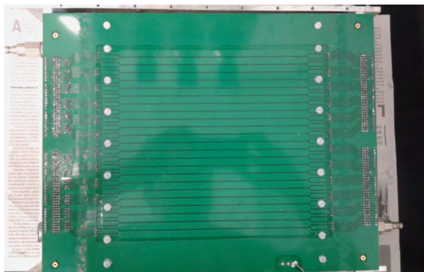
Figura 3.4: PCB del MRPC segmentada con bandas de cobre.
