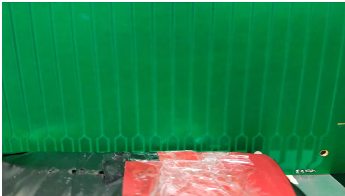
Figura 3.29: Bandas del MRPC que coinciden con la superficie activa de las paletas (marcada en rojo).
