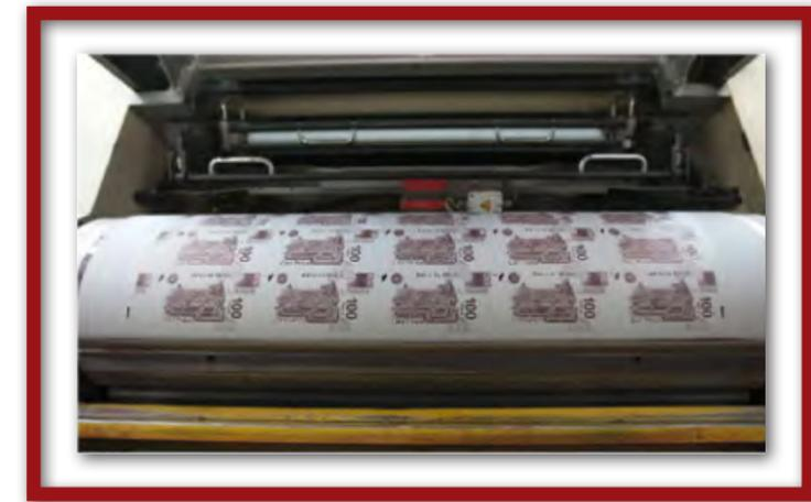
Fig. 52) Imagen de máquina Offset modelo *Simultan* donde se puede apreciar la placa para impresión del reverso del billete de 100 pesos mexicanos.
