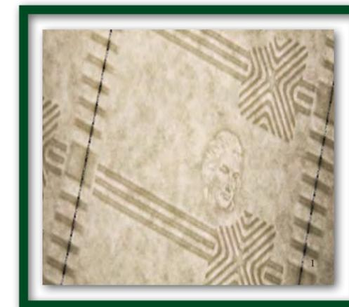
Fig. 85) Detalle del papel para billetes fabricado por la firma De la Rue International Limited con los elementos integrados preparado para su posterior impresión: En la imagen se perciben claramente los hilos de seguridad y las marcas de agua.<sup>1</sup>
