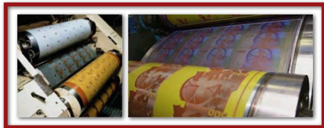
Fig. 51) Máquina Offset modelo *Simultan* para impresión de billetes suecos.
