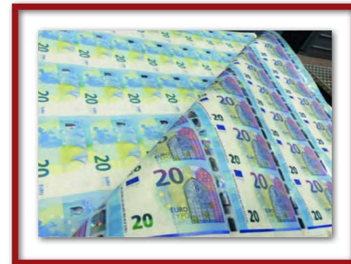
Fig. 84) Imagen de impresiones en pliego del billete de 20 euros en donde se puede apreciar la banda holográfica realizada en *Hot stamping*.
