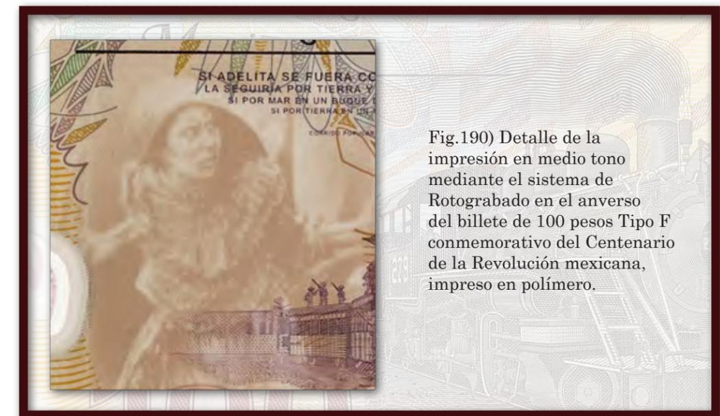
Fig.190) Detalle de la impresión en medio tono mediante el sistema de Rotograbado en el anverso del billete de 100 pesos Tipo F conmemorativo del Centenario de la Revolución mexicana, impreso en polímero.
