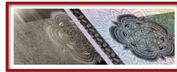
Fig. 56) Detalle de la placa grabada y su impresión calcográfica sobre fondo de seguridad en billete colombiano.
