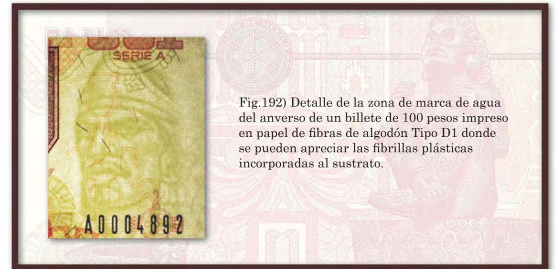
Fig.192) Detalle de la zona de marca de agua del anverso de un billete de 100 pesos impreso en papel de fibras de algodón Tipo D1 donde se pueden apreciar las fibrillas plásticas incorporadas al sustrato.
