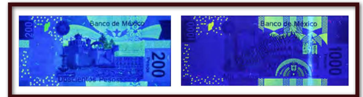
Fig. 179) Anversos de los billetes de 200 y 1000 pesos Tipo F donde podemos apreciar los elementos de seguridad ocultos impresos en Offset con tintas invisibles de respuesta a luz UV.
