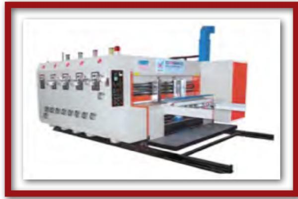
Fig. 79) Ejemplo de máquina de impresión flexográfica industrial.
