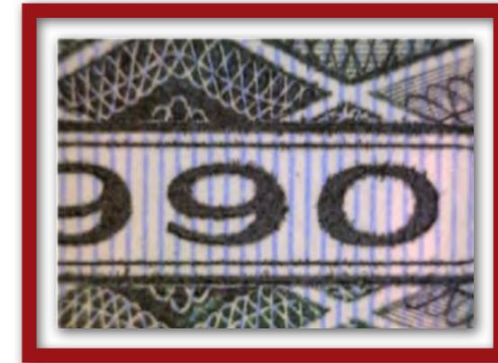
Fig. 62) Acercamiento a impresión calcográfica en billete estadounidense donde se pueden apreciar los filamentos o hilos de tinta, característicos de este sistema de impresión.
