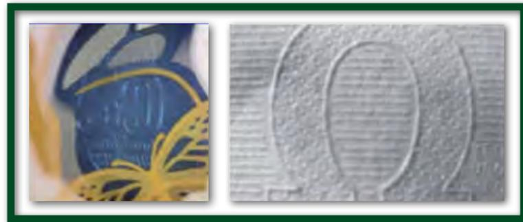
Fig. 117) Izq. Detalle de grabado en seco en ventana transparente en billete mexicano. Der. Detalle del estampado en seco del microtexto de un euro.
