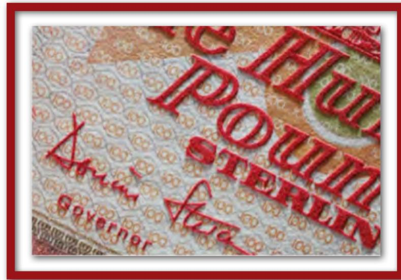
Fig. 61) Fotomicrografía de impresión calcográfica en un billete de 100 libras esterlinas. (Detalle).
