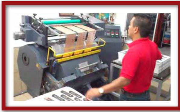
Fig. 82) Ejemplo de máquina de impresión por *Hot Stamping*.
