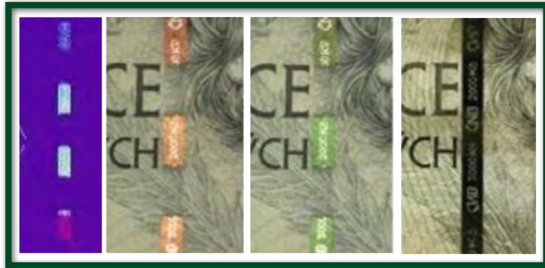
Fig. 134) Izq. Detalle de billete de Malasia. Vista del hilo con reacción bajo luz UV con luminiscencia en distintos colores. Las dos imágenes en el centro: Detalle de hilo aventanillado en billete checo. Al variar el ángulo de observación se produce un efecto de variabilidad del color. Derecha: Mismo hilo visto a trasluz.
