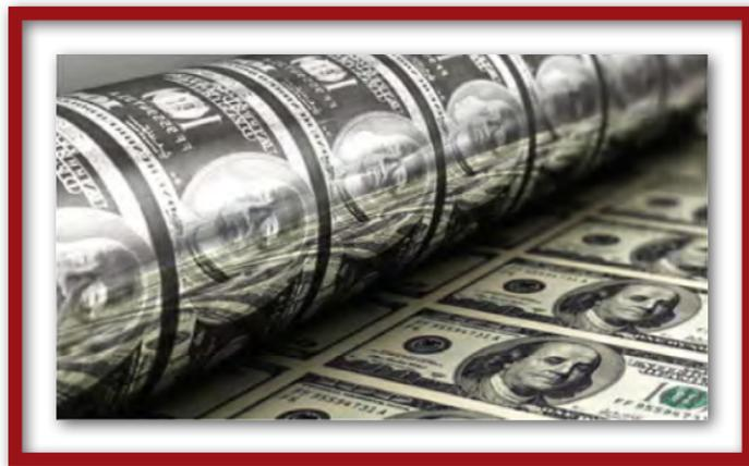
Fig. 58) Detalle de matriz calcográfica en rodillo para la impresión de dólares estadounidenses.
