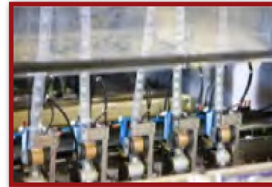
Fig. 15) Detalle de máquina que aplica la banda holográfica de seguridad en la fabricación de papel para billetes.
