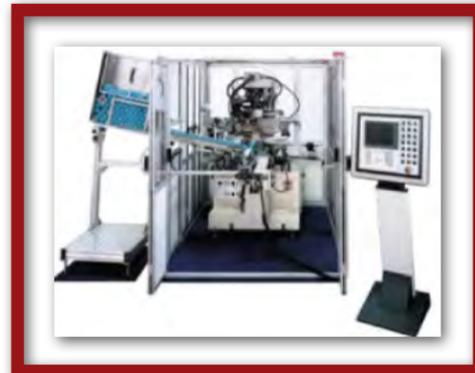
Fig. 83) Ejemplo de máquina industrial de impresión por *Hot Stamping*.
