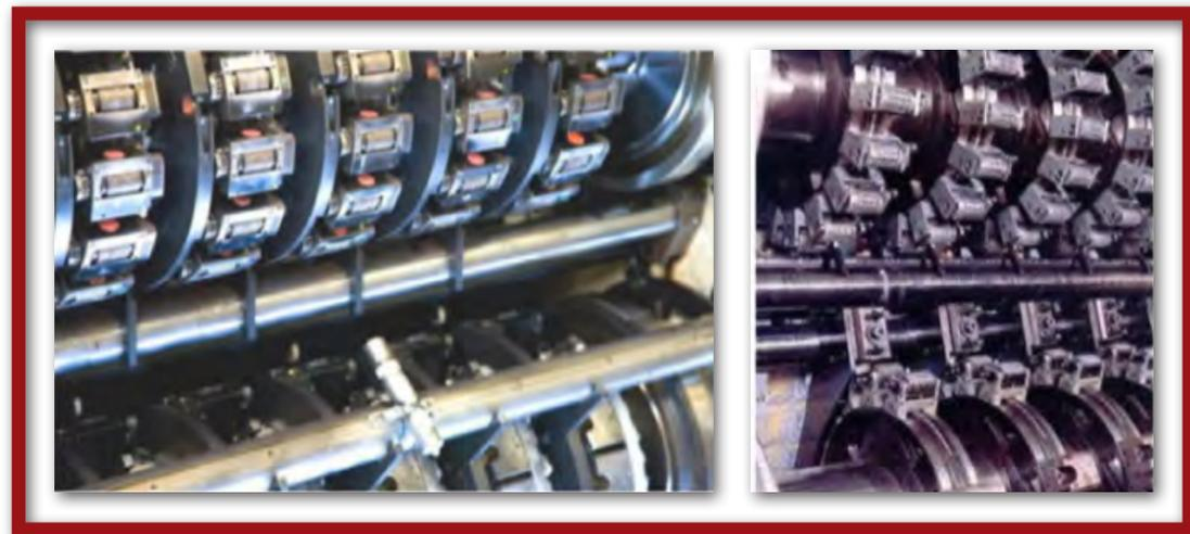
Fig. 68b) Ejemplos de máquinas cilíndricas donde se montan los bloques de numeración para la impresión tipográfica de los folios en billetes.
