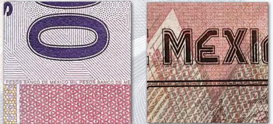
Fig. 176) Detalle del anverso del billete de 500 pesos Tipo D1 (izq) y reverso del de 1000 pesos Tipo F (der.) impresos sobre papel de fibras de algodón, donde podemos ver los acercamientos a los microtextos en los fondos de seguridad impresos en Offset.
