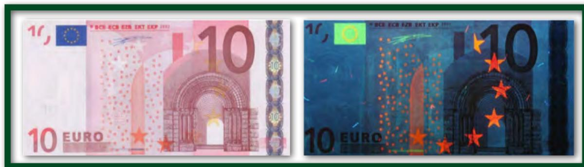
Fig. 100) Anverso del billete de 10 euros (emisión 2002) con luz blanca (izq.) y expuesto a luz UV (der.) donde se observa que el papel permanece opaco, mientras que algunos diseños impresos se destacan con fuerte luminiscencia.
