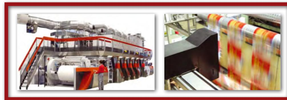
Fig. 74) Izq. Máquina de Rotograbado. Der. Ejemplo de impresión de Rotograbado sobre película.
