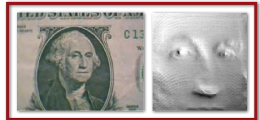
Fig. 42) Tinta magnética en un dólar estadounidense visto mediante escaner magnético.
