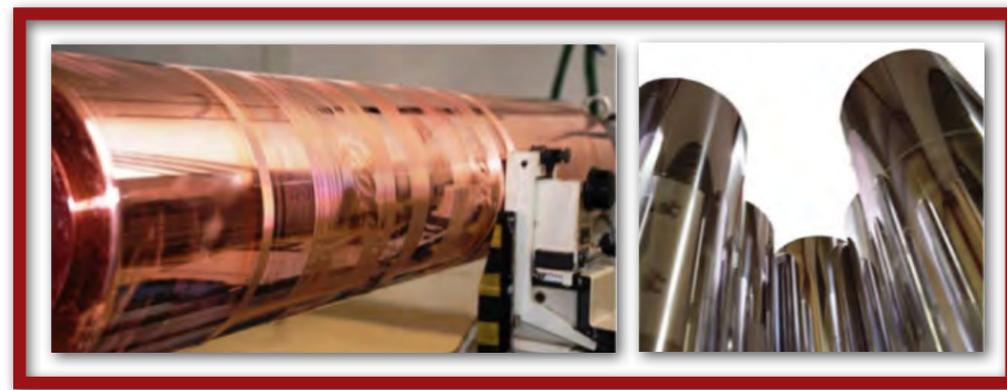
Fig. 73) Imágenes de rodillos para máquinas de Rotograbado. Izq. Grabado de rodillo de cobre. Der. Los rodillos de cobre son cromados para la impresión.
