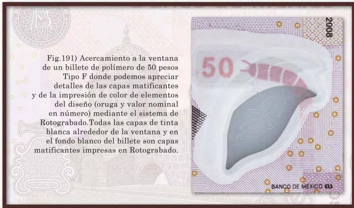
Fig.191) Acercamiento a la ventana de un billete de polímero de 50 pesos Tipo F donde podemos apreciar detalles de las capas matificantes y de la impresión de color de elementos del diseño (oruga y valor nominal en número) mediante el sistema de Rotograbado. Todas las capas de tinta blanca alrededor de la ventana y en el fondo blanco del billete son capas matificantes impresas en Rotograbado.
