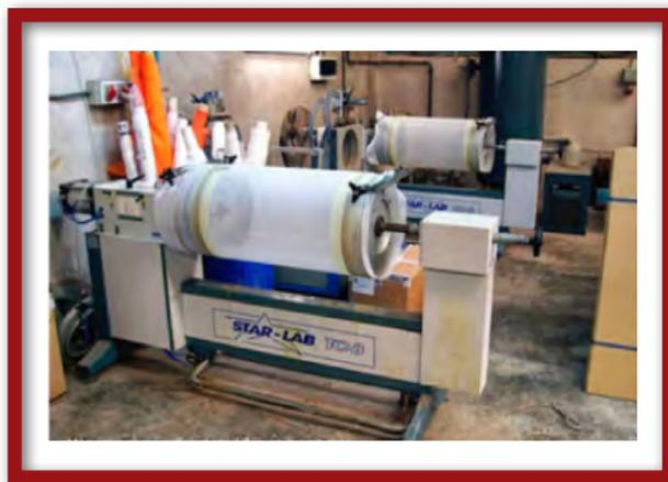
Fig. 76) Ejemplo de máquina para serigrafía industrial de pantallas rotativas.
