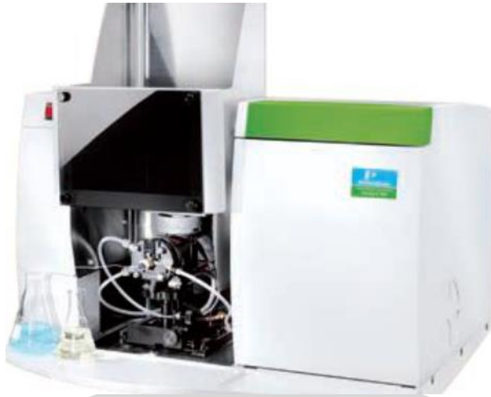
Figura 14. Espectrómetro de Absorción Atómica Perkin Elmer “AAnalys 400”. [12]
