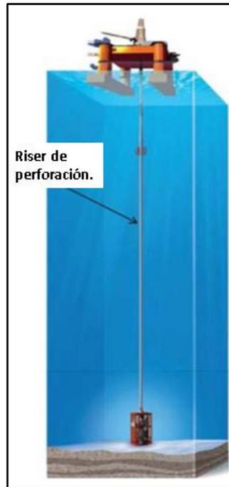
Figura. 1.18 Riser de perforación. (Bravo, 2009).
