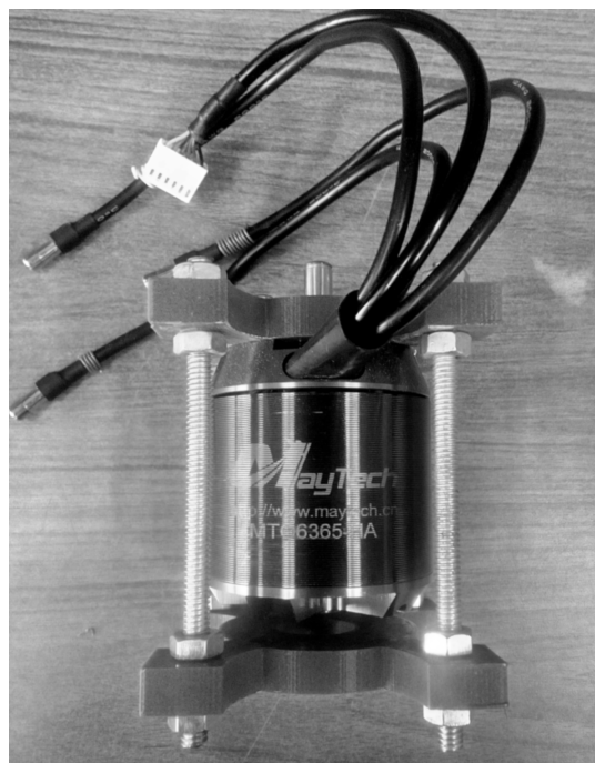
FIGURA 3.2: Motor BLDC Outrunner MTO6365HA-220.
