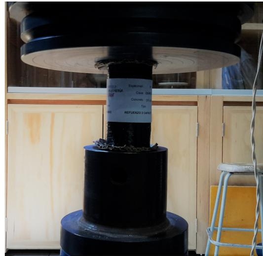
(b) Prueba de compresión axial en el espécimen reforzado con fibra de carbono: el espécimen se coloca en la máquina universal de pruebas mecánicas.
