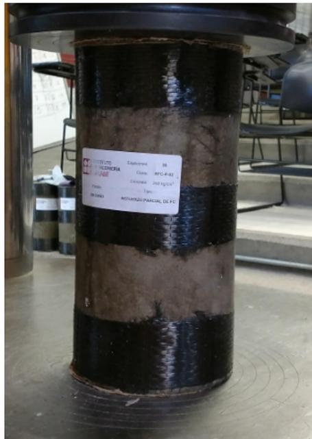
(c) Espécimen reforzado parcialmente con fibra de carbono (RFC-P).
