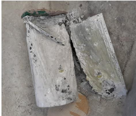
Figura 4.23: La falla de los especímenes con daño interno sucedió en la grieta simulada.
