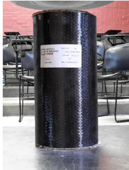
(b) Espécimen reforzado con fibra de carbono (RFC-1, RFC-2, RFC-3, C20-RFC-1, C20-RFC-2, C8-RFC-1, C8-RFC-2).
