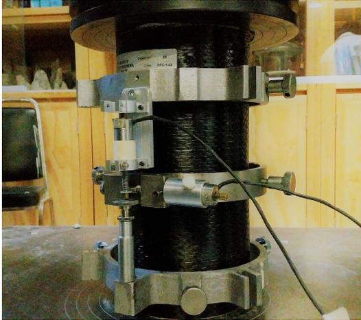
(a) Colocación de los extensómetros en el espécimen
