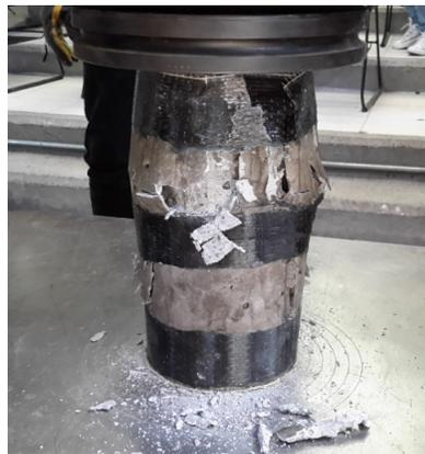
Figura 4.24: Falla de los especímenes con refuerzo parcial de fibra de carbono.
