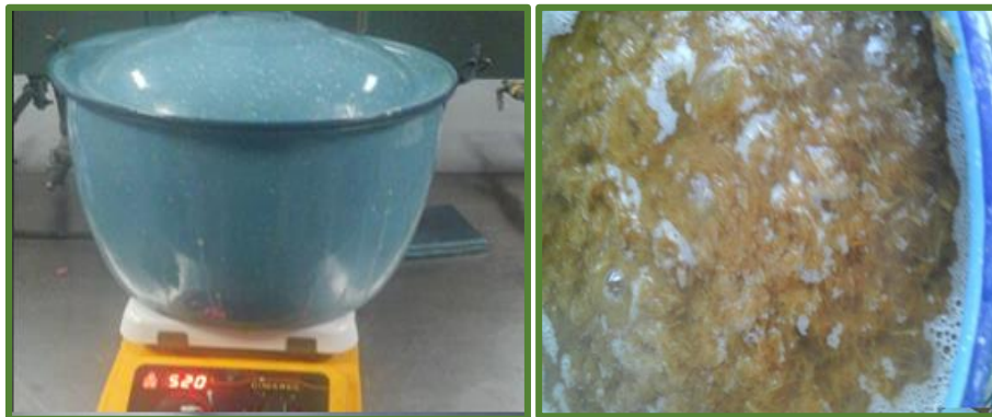
Figura 20. Digestión de la fibra de higuierilla con calentamiento eléctrico
