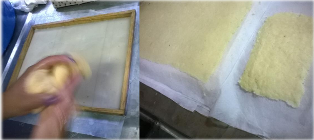
Figura 38. Moldeado de las fibras para convertir en hojas
