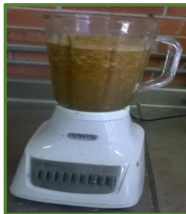
Figura 22. Desfibrado mecánico de la fibra ya cocida.
