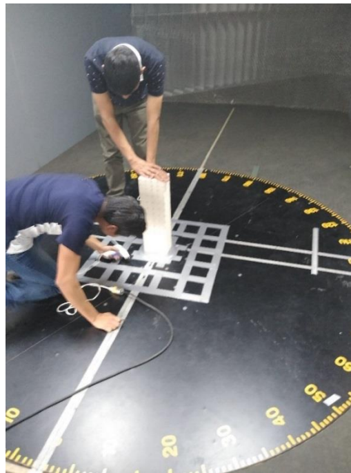
Figura 18 Fijado de modelo en la sección de pruebas.
