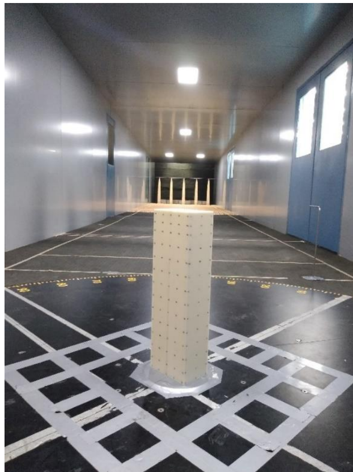
Figura 9 Vista del modelo y sistema de rugosidades y agujas para una categoría de terreno 2
