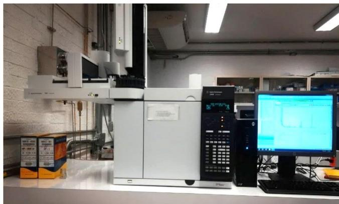
Figura 3.4 Cromatógrafo de gases *Agilent 7890B*, utilizado en el análisis experimental.
