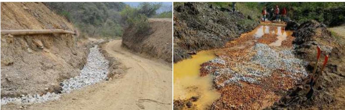
Figura 5. Prueba de neutralización de DAM en Taxco, Guerrero con rocas calizas y lutita calcárea de la zona.
