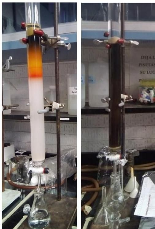
**Figura 23.** Columna cromatográfica al inicio y al final de la elusión con diferentes polaridades.
