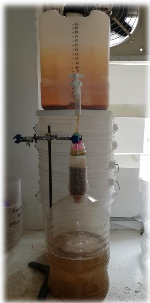
Figura 11. Sistema de tratamiento en el que se pueden apreciar todas las partes ensambladas. Imagen que representa la primera prueba para determinar el volumen de DAM que se agregará en cada uno de los experimentos del diseño.
