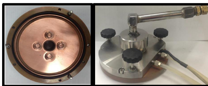
Figura 23. Platina empleada para el proceso de succión en molde de Cu
