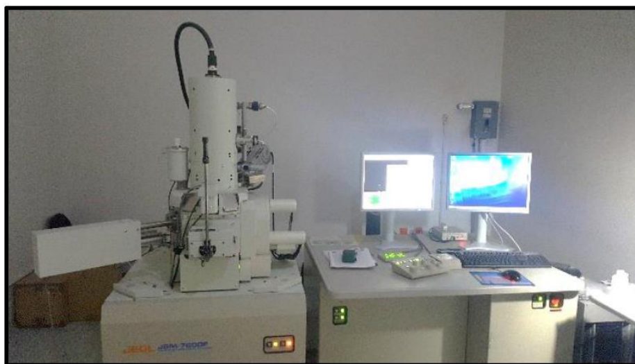
Figura 28. Microscopio electrónico de barrido JEOL-7600F.
