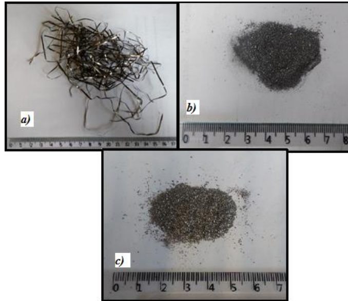
Figura 26. a) Cintas de Gd puro, b) polvo de MnCoSi y c) MnCoSiB 0.5 obtenidas por “melt-spinning”
