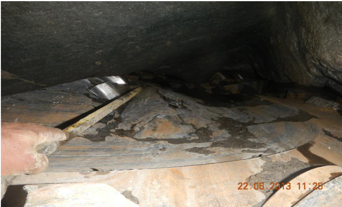
Figura 266. Desgaste en rueda de corte.
