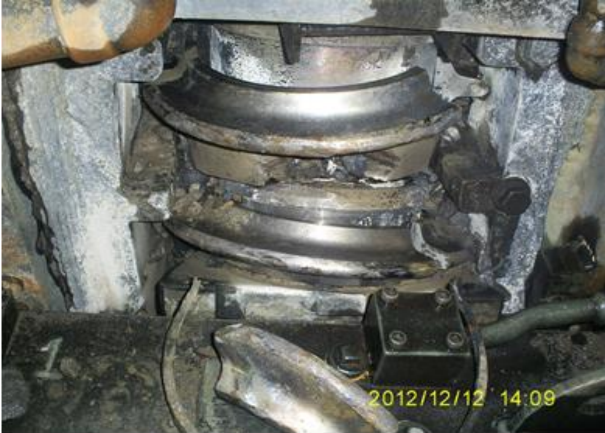
Figura 263. Daño presentado en un cortador central.
