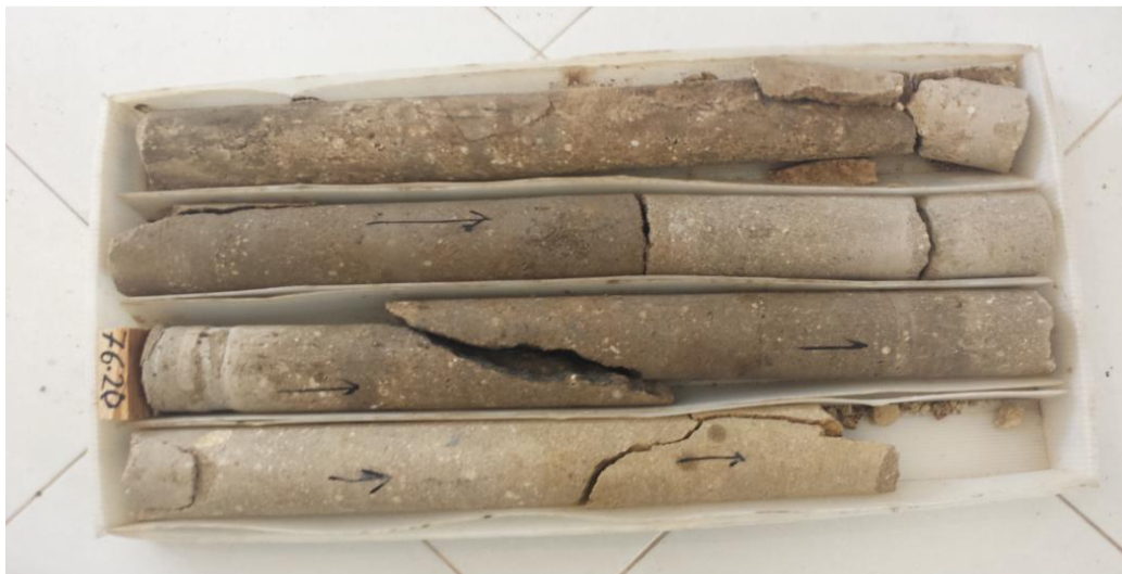
Figura 24. Muestras inalteradas mediante la utilización del tubo shelby.
