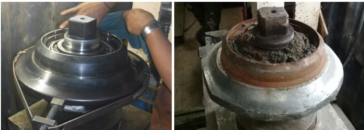
Figura 213. Ingreso de material fino al interior del disco cortador.
