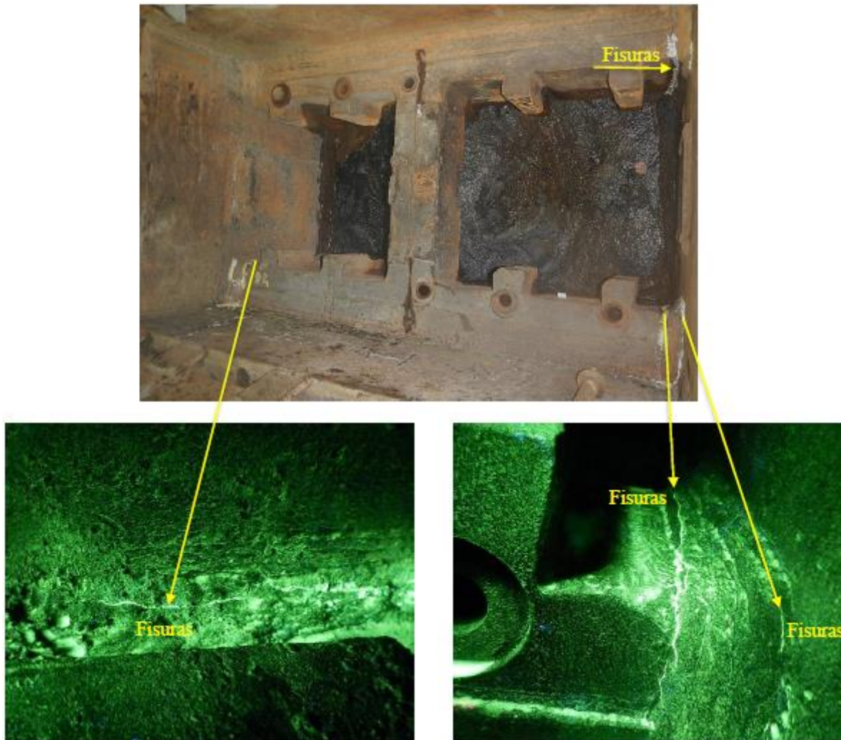
Figura 268. Resultados de la inspección por partículas magnéticas.
