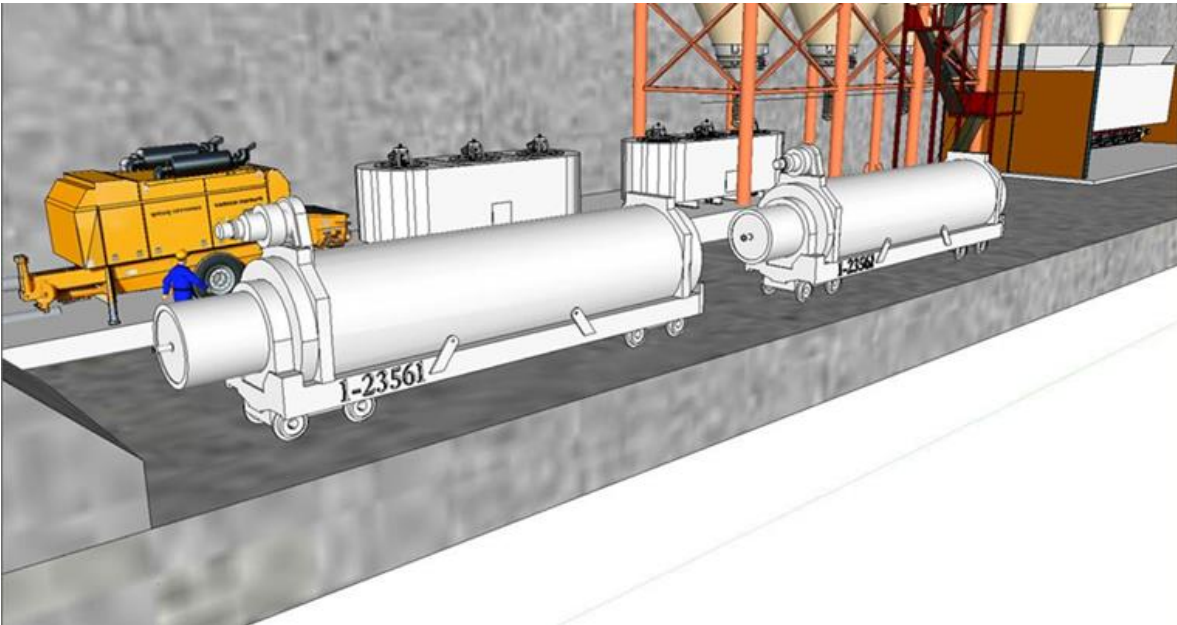
Figura 21. Carros Moran para transporte de concreto.
