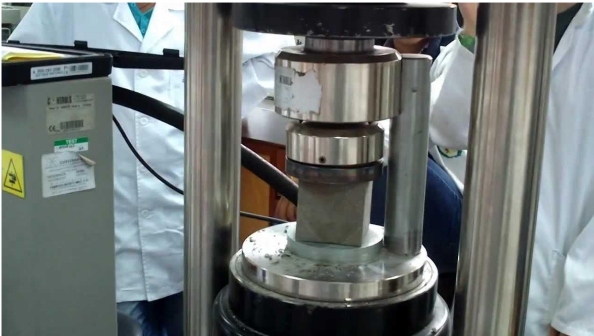
Figura 324. Prueba de compresión del mortero.
