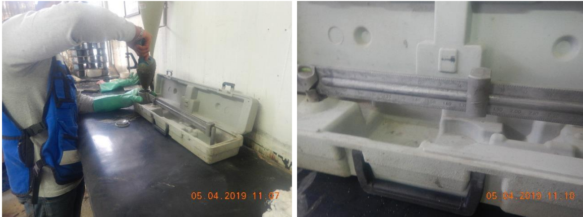
Figura 321. Obtención de la densidad del mortero.
