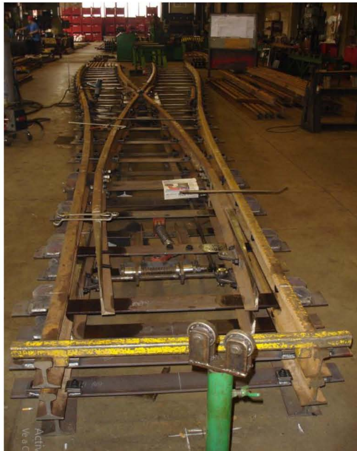
Figura 134. Configuración de vías centrales y cambio California.
