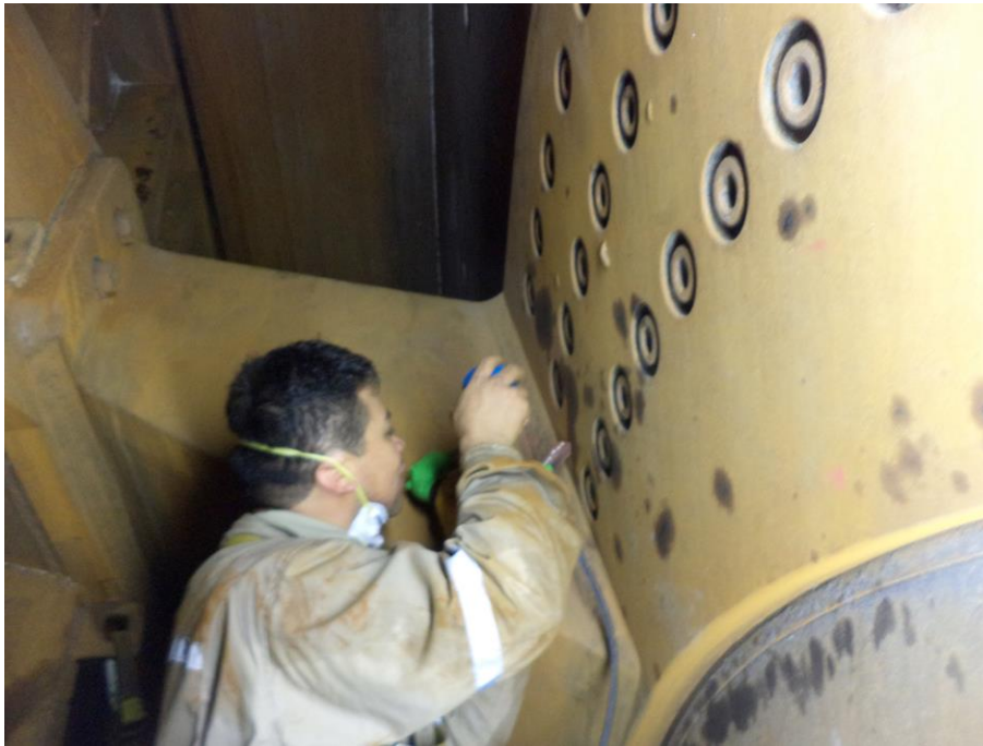
Figura 265. Inspección por partículas magnéticas.
